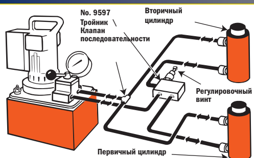
6 Цилиндр двустороннего действия с клапаном последовательности, регулирующим контуры первичного и вторичного цилиндров
