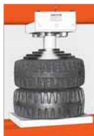
прессовка обода в новую шину на прессе Power Team
