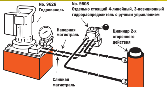
4 Цилиндры двустороннего действия в контуре, управляемом дистанционным клапаном
