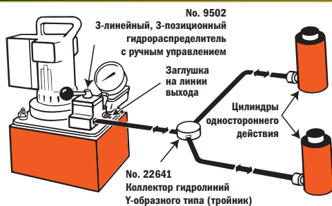
1 Цилиндр или цилиндры одностороннего действия в контуре, управляемом установленным на насосе клапаном
