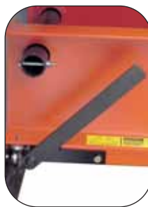
Рычаг опускает нижнюю платформу для прессинга и поднимает для прокатки.
