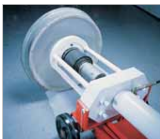
На верхнем снимке показан универсальный съемник, установленный на роликовом подшипнике в сборе и готовый к выпрессовке подшипника
