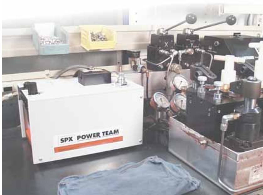
Насос PA60 в работе
