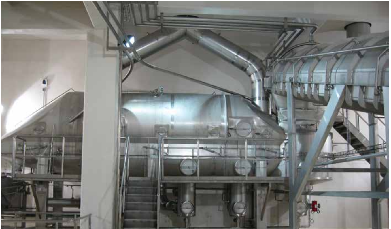
Sektion eines Milchtrocknungssystems – Fließbett und Kristallisationsförderer
