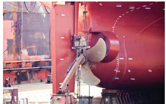
上图：船舵常规安装 在干船坞进行维护。
