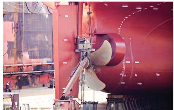
위 사진: 드라이 전용 정기 유지보수를 위한 키 설치 아래: 설치 시 HVAC 장비 포지셔닝
