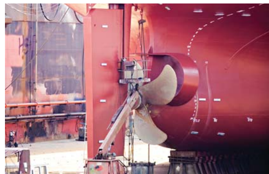
Hierboven in beeld: een roerinstallatie wordt in een droogdok geplaatst voor routinematig onderhoud.
