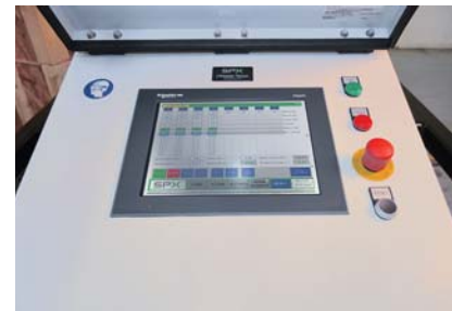
Het homescreen van het Motion Control System is gebruikersvriendelijk. Alle activiteiten van het Motion Control System zijn gemakkelijk te volgen. De performance van iedere cilinder die in bedrijf is, wordt geregistreerd en is te bekijken op het HMI-scherm, zoals hieronder is weergegeven.
