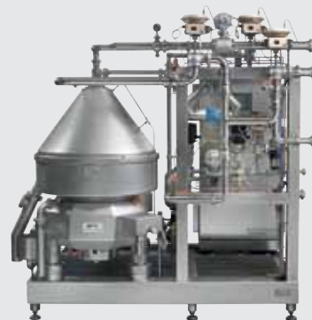
Mlékárenství- odstředivka mléka s automatickým standardizačním systémem pro mléko a smetanu
