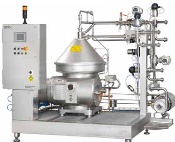
Průmysl – Separátor pro separaci polymerů a monomerů
