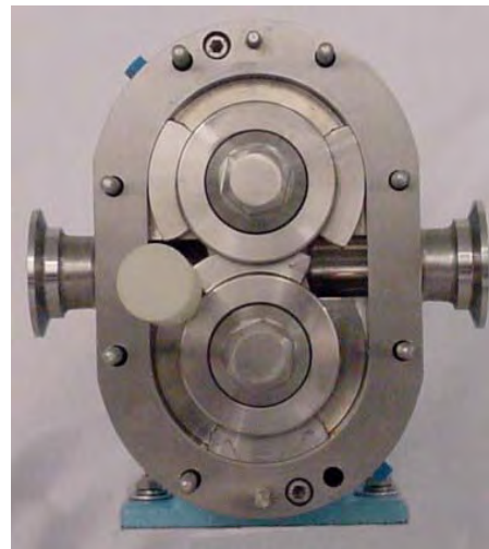
Rys. 41 Umiejscowienie trzpienia zabezpieczającego do zdjęcia dolnego wirnika
