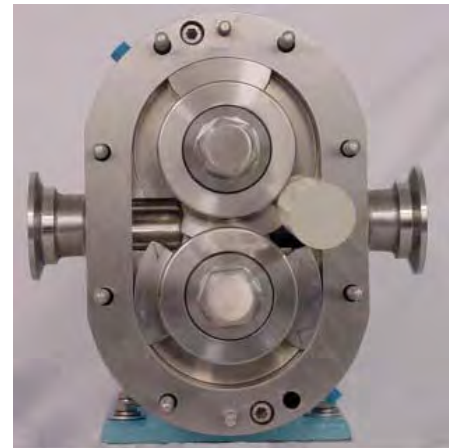
Rys. 40 Umiejscowienie trzpienia zabezpieczającego do zdjęcia górnego wirnika
