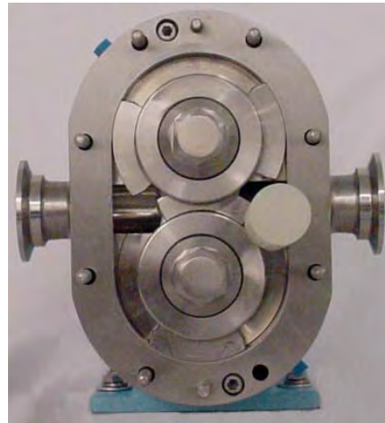
Rys. 84 Umiejscowienie trzpienia zabezpieczającego do dokręcania dolnego wirnika
