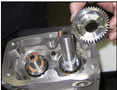
Obrázek 202 - Nainstalujte hnací kolo
