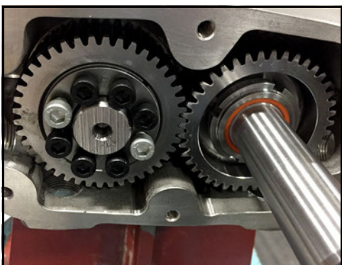
Obrázek 214 - Vyrovnajte volné kolo s hnacím kolem
