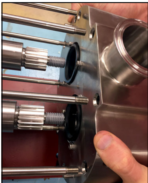
Obrázek 87 - Nainstalujte těleso čerpadla na hřídel
