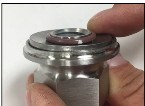
Obrázek 115 - Nainstalovaná talířová pružinová podložka
