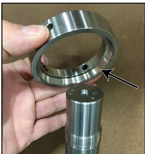
Obrázek 157 - Nasad'te podložku ložiska na hřídel
