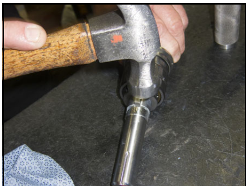
Obrázek 182 - Vsaďte klepnutím klín do klínové drážky
