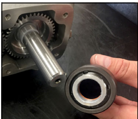
Obrázek 142 - Demontujte pojistnou matici a převod
