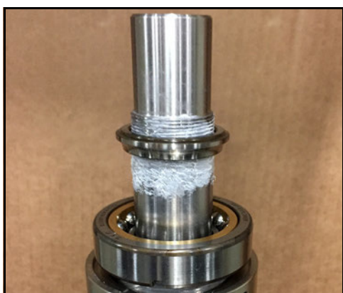
Obrázek 171 - Nasad'te oběžnou drážku na hřídel
