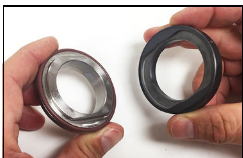
Obrázek 44 - Z víka ucpávky demontujte sedlo ucpávky
