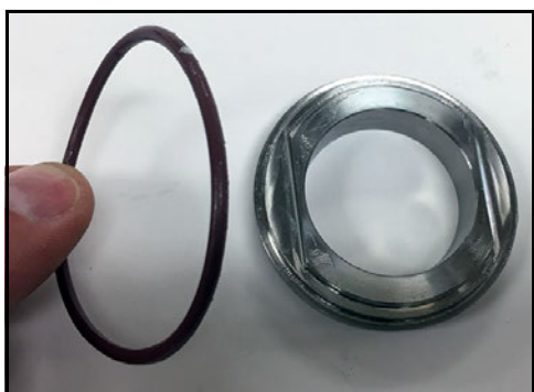
Obrázek 97 - Nainstalujte O-kroužek mezi víkem a sedlem
