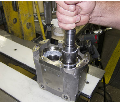
Obrázek 186 - Vložte do otvoru krátkou hřídel
