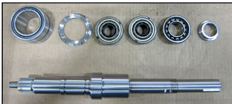
Obrázek 150 - Hnací hřídel: Položky potřebné pro montáž
