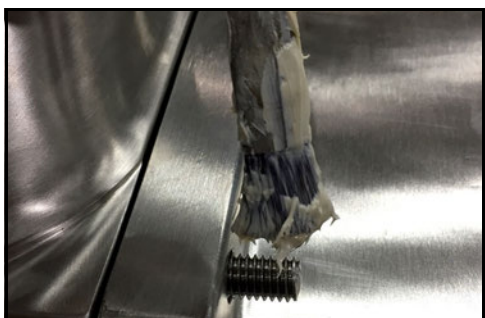
Obrázek 131 - Naneste na závity prostředek proti „srůstání“ závitu
