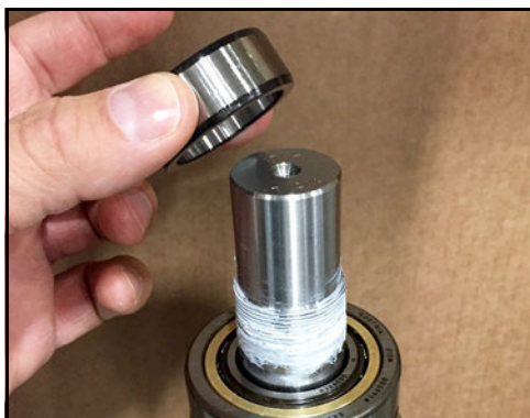
Obrázek 175 - Nasad'te oběžnou drážku na hřídel
