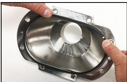
Obrázek 29 - Odstraňte ploché těsnění krytu
