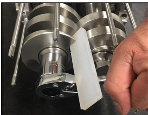
Obrázek 219 - Nainstalujte matice rotorů
