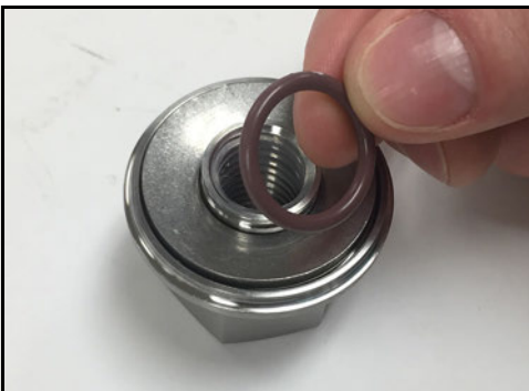
Obrázek 39 - Vyměňte O-kroužek přidržující podložku
