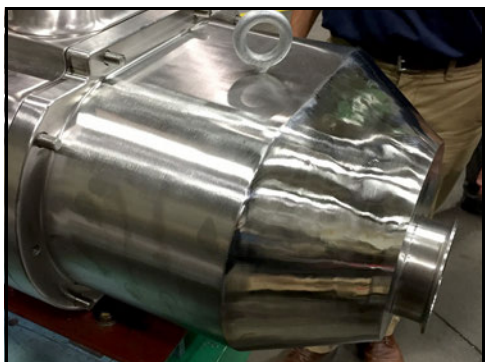
Obrázek 130 - Doražte kryt čerpadla na těleso čerpadla
