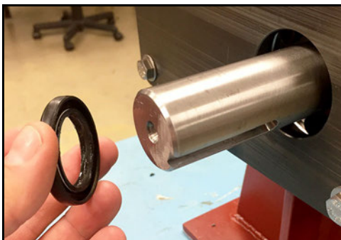
Obrázek 238 - Nainstalujte olejové těsnění
