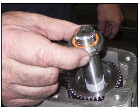
Obrázek 204 - Nainstalujte pojistnou matici
