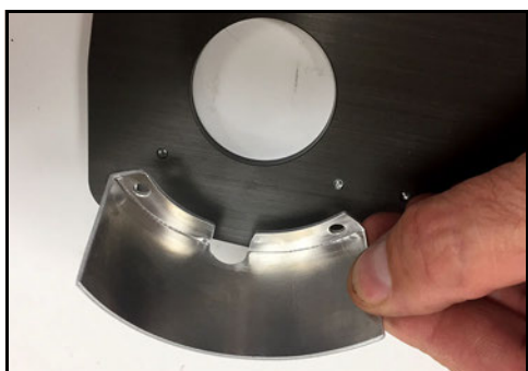
Obrázek 230 - Vyrovnajte otvory pro šrouby
