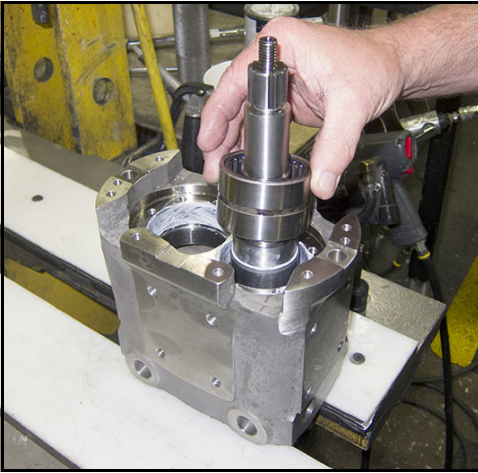
Obrázek 188 - Nasad'te na hřídel vnější oběžnou drážku
