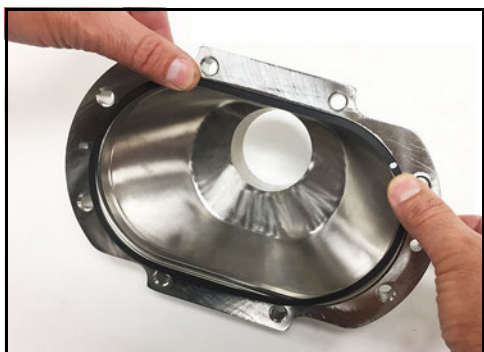
Obrázek 127 - Nainstalujte ploché těsnění krytu
