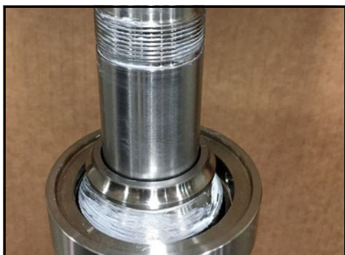
Obrázek 164 - Oběžná drážka natlačená na hřídeli
