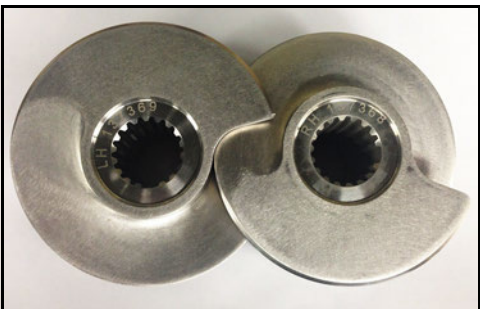
Obrázek 107 - Uspořádání rotorů: levý-pravý
