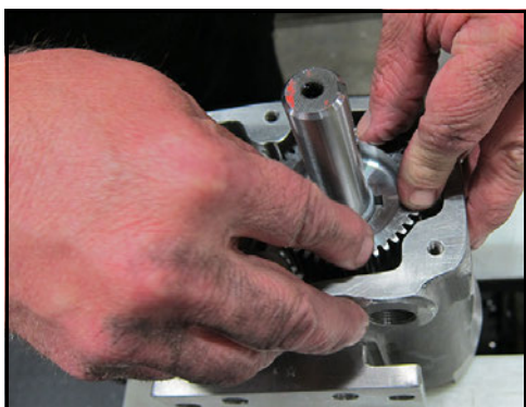
Obrázek 203 - Nainstalujte hnací kolo
