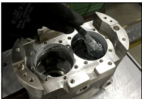
Obrázek 184 - Použijte prostředek proti „srůstání“ závitů
