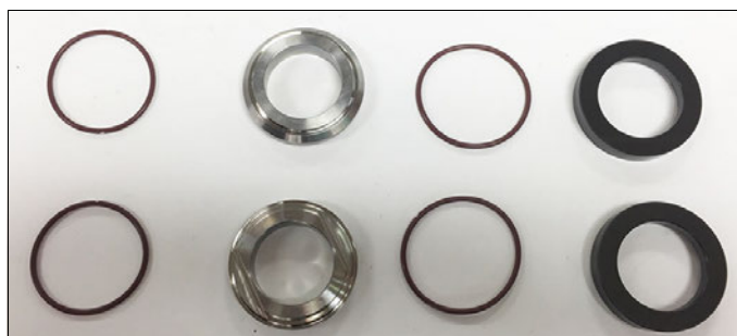
Obrázek 96 - Součásti sestavy víka ucpávky
