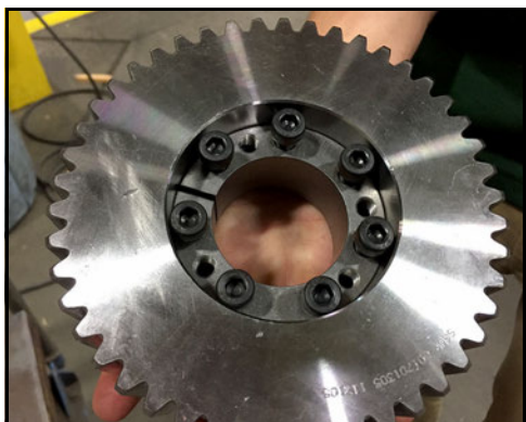
Obrázek 212 - Nasadte pojistnou sestavu na kolo
