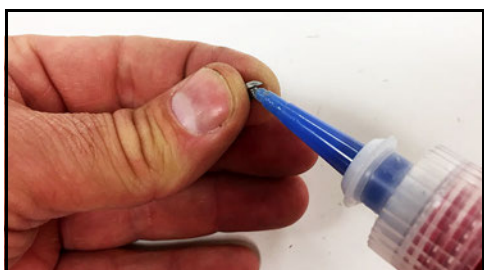
Obrázek 231 - Naneste přípravek Loctite®
