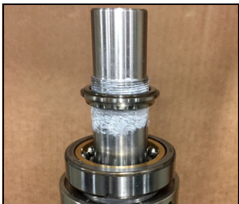
Obrázek 166 - Nasad'te oběžnou drážku na hřídel
