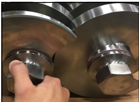
Obrázek 124 - Nainstalujte matice rotorů
