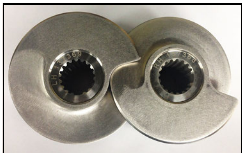
Obrázek 42 - Uspořádání rotorů: levý – pravý
