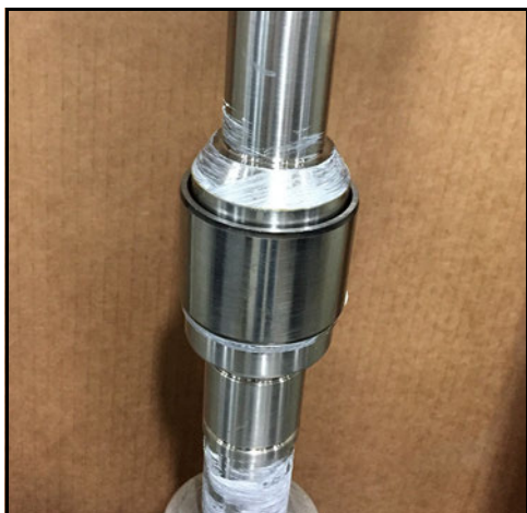
Obrázek 156 - Vnitřní oběžná drážka nainstalovaná na hřídeli
