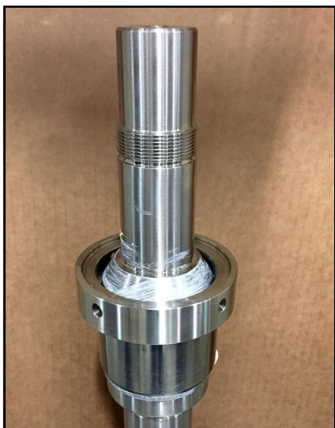
Obrázek 158 - Nainstalovaná podložka ložiska
