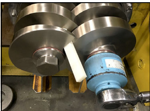
Obrázek 36 - Vložte nástroj pro blokování
