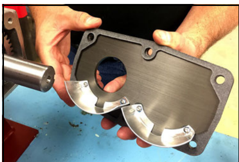
Obrázek 234 - Umístěte na kryt ploché těsnění
