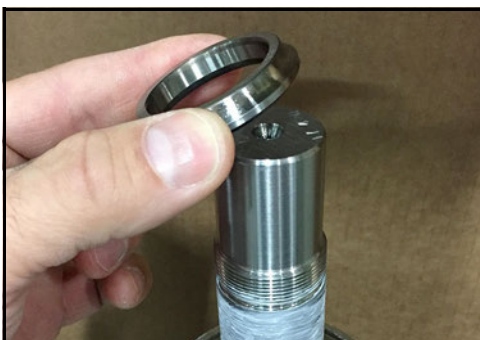
Obrázek 162 - Nasad'te oběžnou drážku na hřídel
