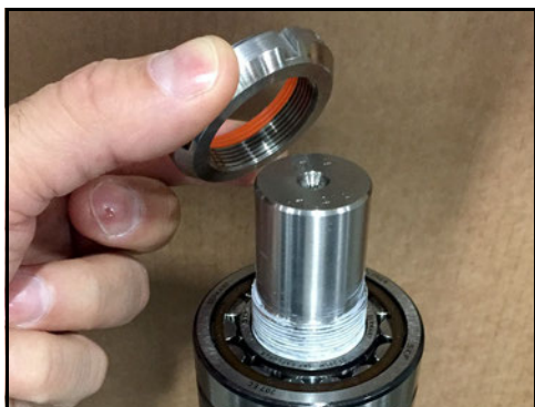
Obrázek 178 - Nasad'te na hřídel pojistnou matici
