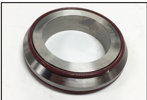
Obrázek 100 - Nainstalovaný O-kroužek mezi víkem a rotorem
