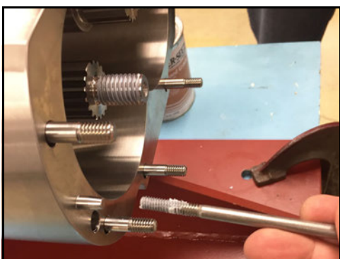
Obrázek 51 - Demontujte šrouby upevňující těleso
