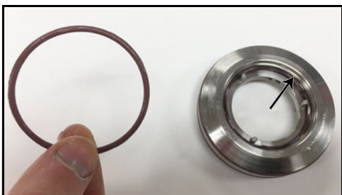
Obrázek 69 - O-kroužek mezi unašečem a ucpávkou
