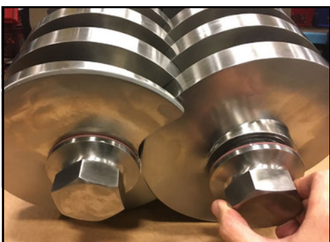
Obrázek 37 - Sejměte matice rotorů
