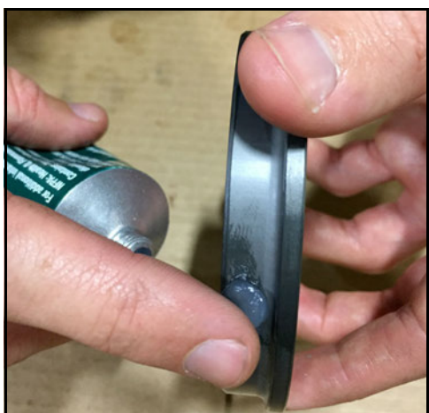
Obrázek 81 - Namažte vnější průměr ucpávky
