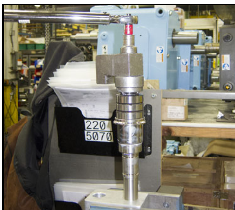
Obrázek 179 - Dotáhněte pojistnou matici na předepsaný moment
