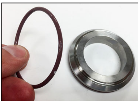
Obrázek 45 - Vyjměte O-kroužek mezi víkem a rotorem
