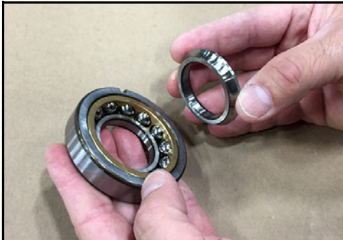
Obrázek 160 - Vyjměte spodní oběžnou drážku
