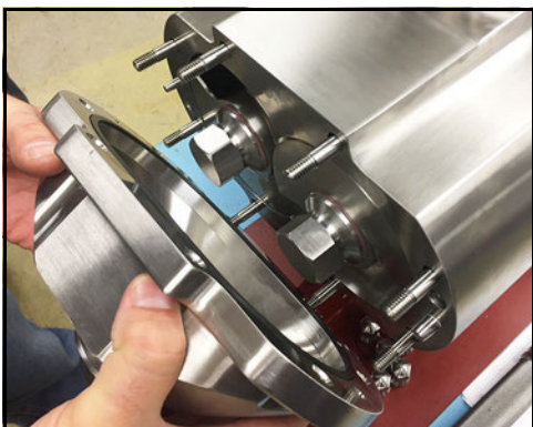
Obrázek 28 - Demontujte kryt čerpadla
