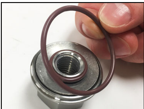
Obrázek 116 - Nainstalujte O-kroužek matice rotoru
