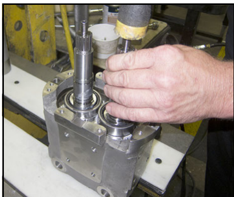
Obrázek 191 - Klepnutím hřídele v otvorech vycentrujte
