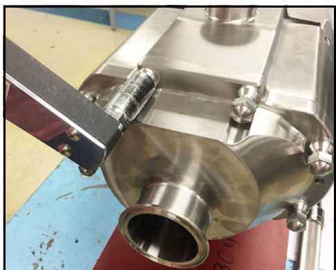
Obrázek 132 - Dotáhněte matice krytu
