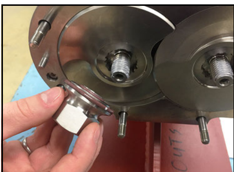
Obrázek 119 - Nainstalujte matice rotorů
