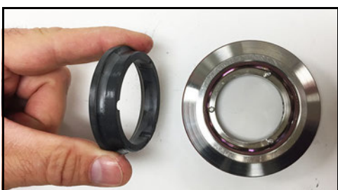
Obrázek 73 - Namažte a nainstalujte ucpávku
