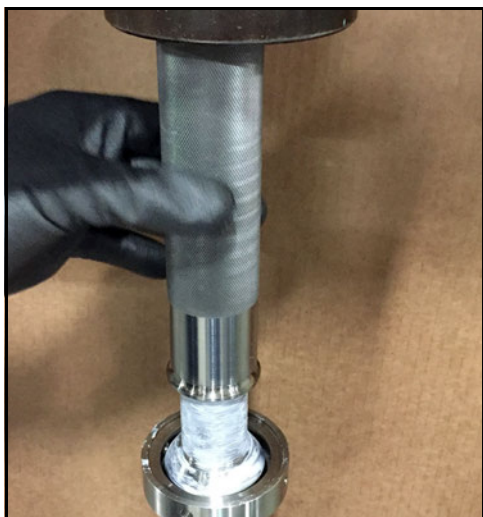
Obrázek 163 - Natlačte oběžnou drážku na hřídel
