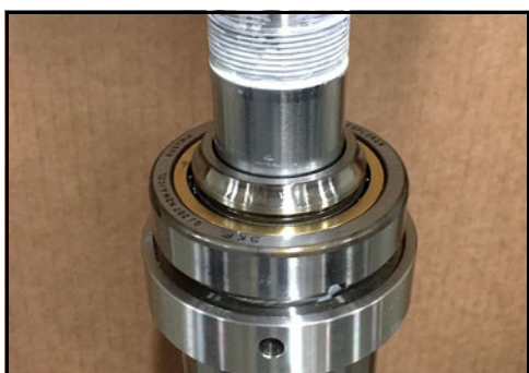
Obrázek 169 - Natlačte oběžnou drážku do ložiska
