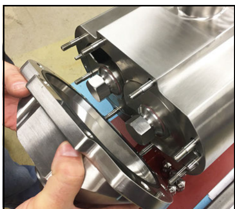
Obrázek 128 - Nainstalujte kryt čerpadla
