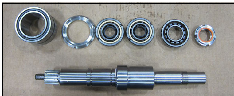
Obrázek 151 - Krátká hřídel: Položky potřebné pro montáž
