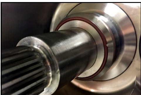
Obrázek 104 - Víko ucpávky nasazené na hřídeli
