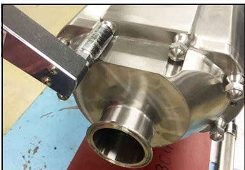
Obrázek 27 - Vyšroubujte matice z krytu
