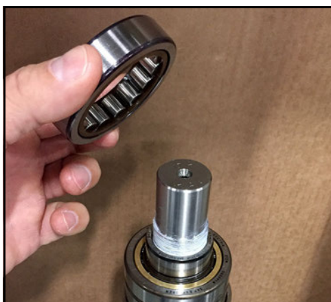
Obrázek 177 - Umístěte ložisko na oběžnou drážku
