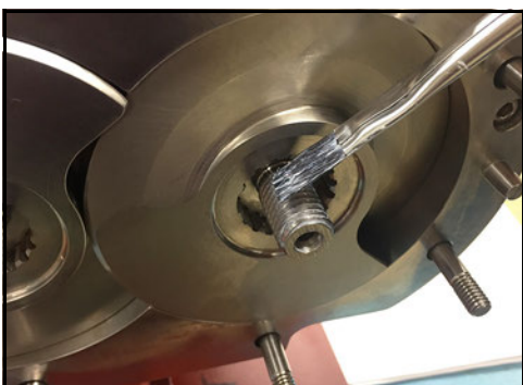
Obrázek 118 - Použijte prostředek proti „srůstání“ závitů
