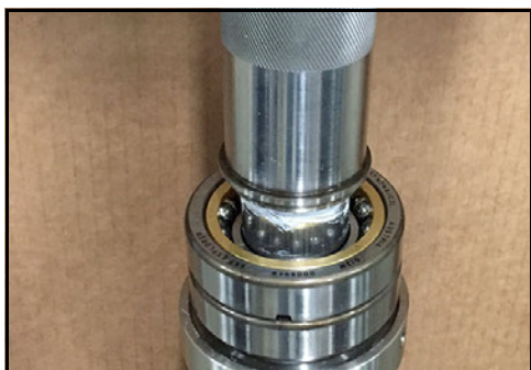
Obrázek 172 - Natlačte oběžnou drážku do ložiska
