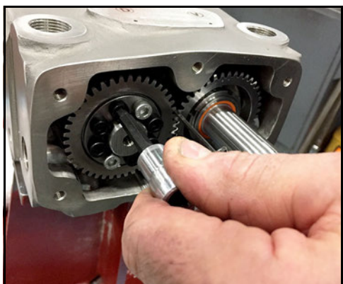
Obrázek 226 - Ručně dotáhněte šrouby pojistné sestavy
