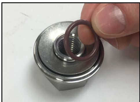
Obrázek 114 - Nainstalujte O-kroužek přidržující podložku
