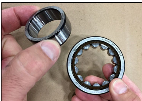
Obrázek 174 - Vyjměte oběžnou drážku z ložiska
