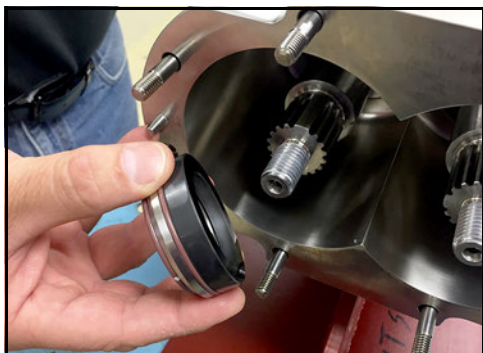
Obrázek 43 - Odstraňte sestavu víka ucpávky
