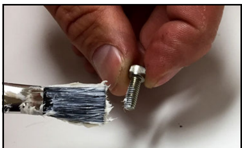
Obrázek 79 - Použijte prostředek proti „srůstání“ závitů
