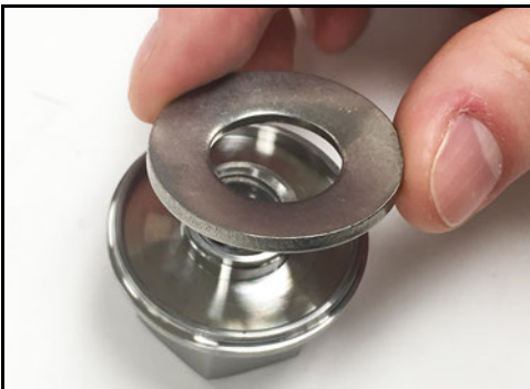
Obrázek 40 - Nainstalujte talířovou pružinovou podložku
