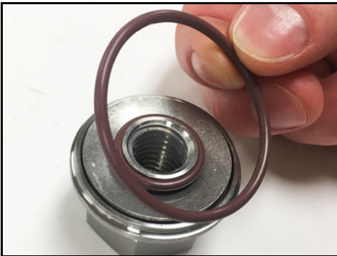
Obrázek 38 - Vyměňte O-kroužek matice rotoru
