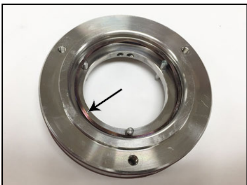
Obrázek 71 - Nainstalovaná vlnová pružina ucpávky
