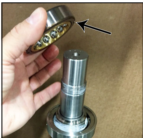
Obrázek 165 - Umístěte ložisko na oběžnou drážku
