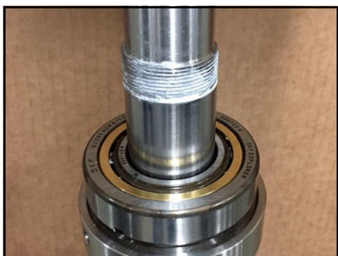
Obrázek 167 - Oběžná drážka nainstalovaná na hřídeli
