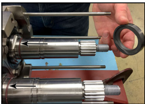
Obrázek 54 - Demontujte O-kroužky hřídele
