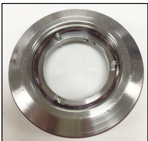
Obrázek 67 - Nainstalovaná vlnová pružina ucpávky
