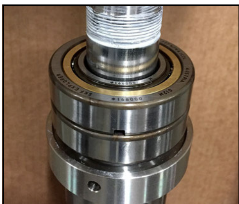
Obrázek 173 - Druhé nainstalované ložisko
