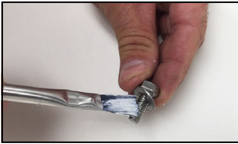
Obrázek 236 - Použijte prostředek proti „srůstání“ závitů
