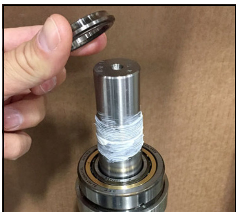
Obrázek 168 - Nasad'te oběžnou drážku na hřídel
