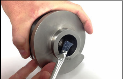
Obrázek 106 - Použijte prostředek proti „srůstání“ závitů
