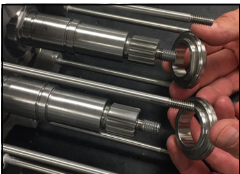
Obrázek 215 - Nainstalujte víka ucpávky
