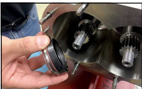
Obrázek 103 - Nainstalujte sestavu víka ucpávky
