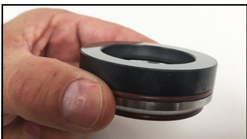
Obrázek 102 - Sedlo ucpávky nainstalované na víko ucpávky
