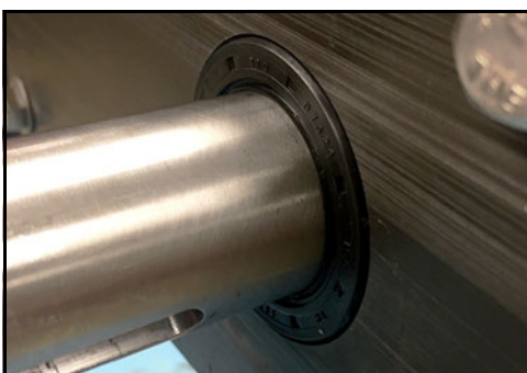
Obrázek 239 - Nainstalované olejové těsnění
