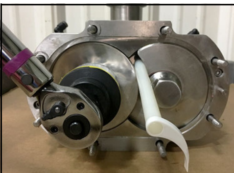
Obrázek 123 - Vložte čepovitou část
