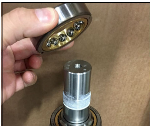
Obrázek 170 - Umístěte ložisko na oběžnou drážku
