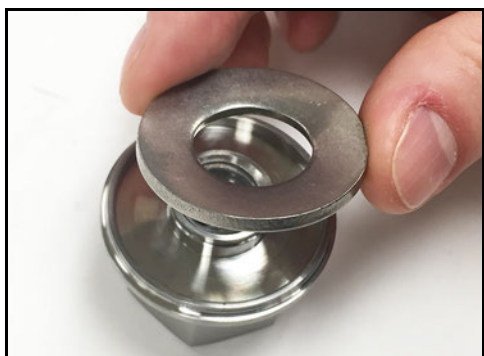
Obrázek 113 - Nainstalujte talířovou pružinovou podložku
