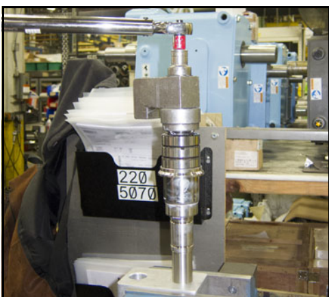
Abbildung 179 - Anziehen der Sicherungsmutter auf Drehmoment
