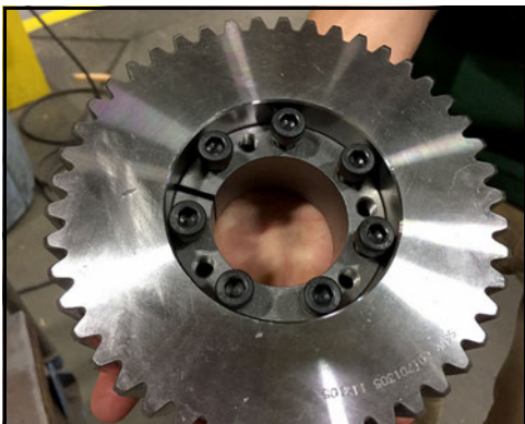
Abbildung 212 - Einsetzen der Sicherungsbaugruppe in das Zahnrad
