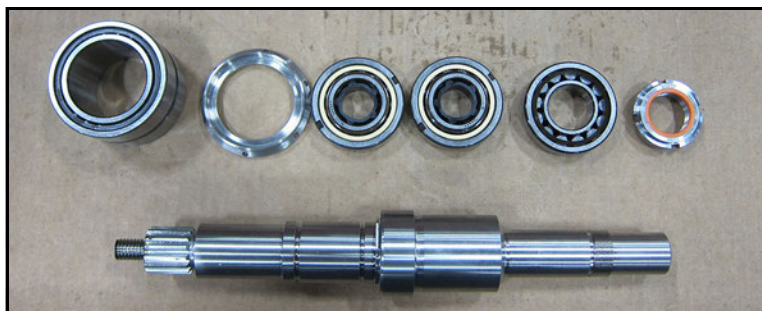
Abbildung 151 - Kurze Welle: Benötigte Elemente der Baugruppe
