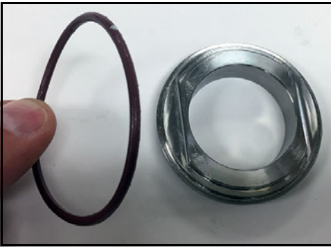
Abbildung 46 - Ausbau des O-Rings zwischen Kappe und Sitz
