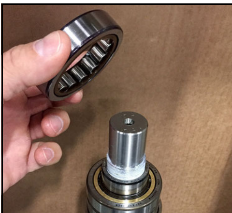
Abbildung 177 - Aufsetzen des Lagers auf den Laufring
