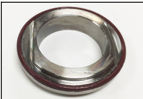
Abbildung 98 - O-Ring zwischen Kappe und Sitz ist montiert
