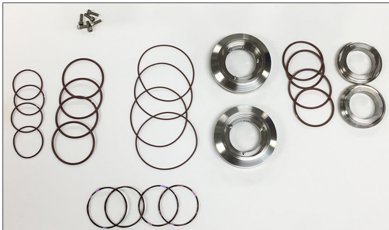
Abbildung 63 - Bestandteile der Dichtungsbaugruppe
