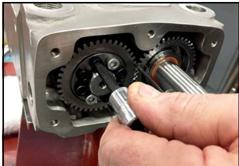
Abbildung 137 - Lösen der Schrauben in der Befestigungsbaugruppe
