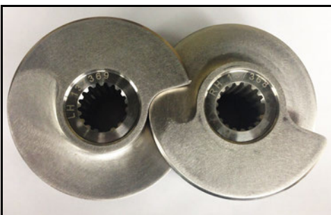
Abbildung 107 - Anordnen der Rotoren: LH-RH (L - R)
