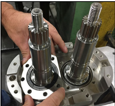
Abbildung 199 - Montage der Lageraufnahme
