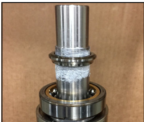
Abbildung 171 - Aufsetzen des Laufrings auf die Welle
