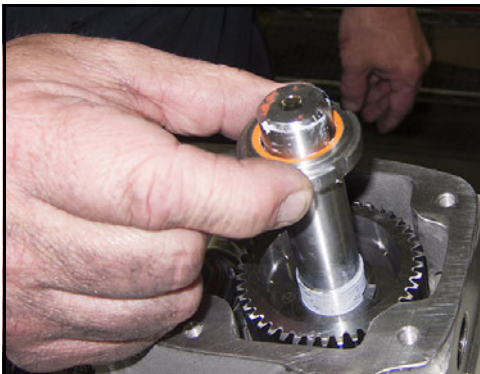
Abbildung 204 - Montage der Sicherungsmutter
