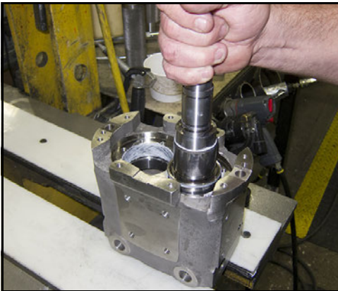
Abbildung 186 - Einsetzen der kurzen Welle in die Bohrung
