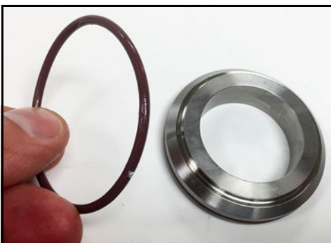
Abbildung 45 - Ausbau des O-Rings zwi- schen Kappe und Rotor
