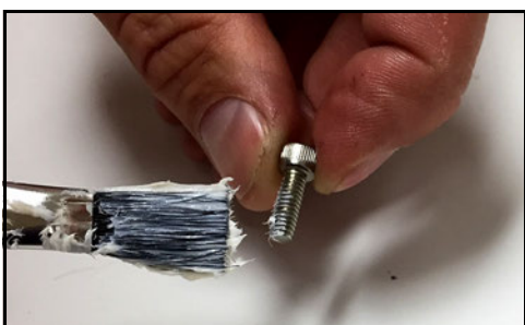
Abbildung 79 - Auftragen von Gleitmittel
