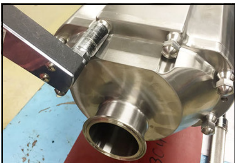
Abbildung 27 - Die Deckelmuttern abschrauben
