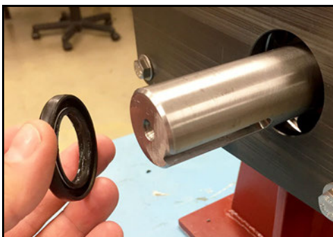
Abbildung 238 - Montage der Öldichtung
