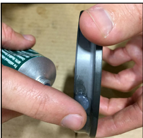
Abbildung 81 - Schmierung des Außenumfangs der Dichtung
