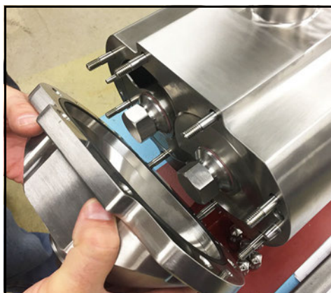
Abbildung 128 - Montage des Pumpendeckels
