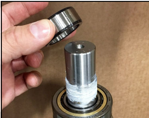
Abbildung 175 - Aufsetzen des Laufrings auf die Welle
