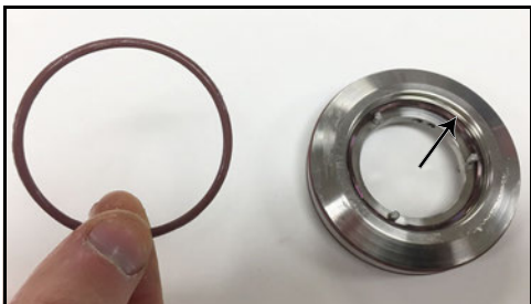
Abbildung 69 - O-Ring zwischen Träger und Dichtung
