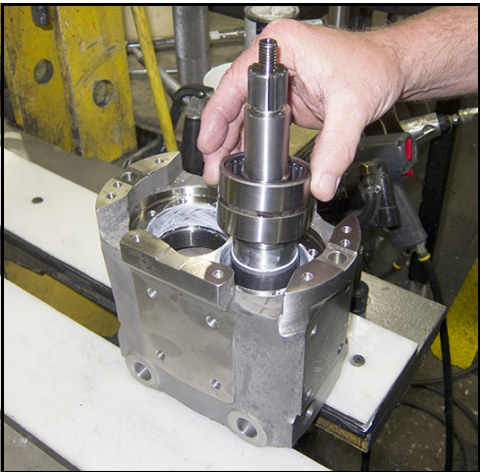
Abbildung 188 - Aufsetzen des Außenrings auf die Welle
