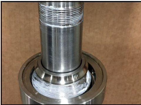
Abbildung 164 - Auf die Welle gepresster Laufring
