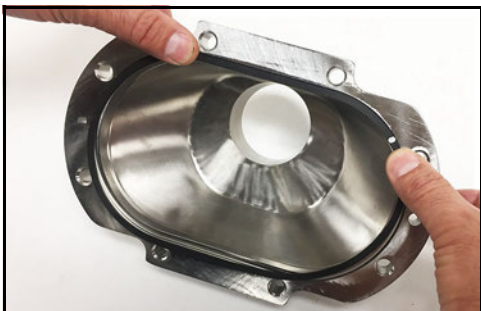
Abbildung 29 - Herausnehmen der Deckeldichtung
