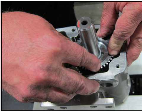
Abbildung 203 - Montage des Antriebszahnrad
