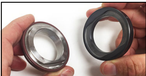
Abbildung 101 - Fluchten von Dichtungskappe und Dichtungssitz
