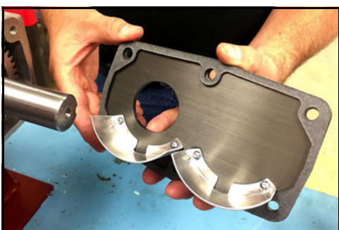
Abbildung 234 - Dichtung auf den Deckel aufsetzen
