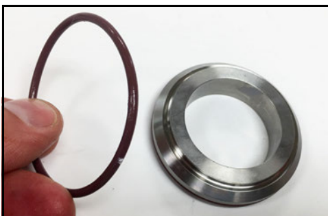
Abbildung 99 - Montage des O-Rings zwischen Kappe und Rotor
