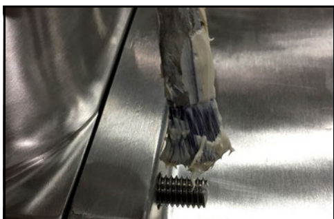
Abbildung 131 - Gleitmittel auf die Gewinde auftragen
