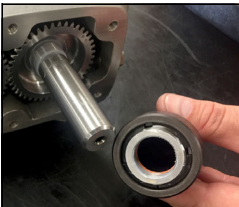
Abbildung 142 - Entfernen Sie die Befestigungsmutter und das Zahnrad
