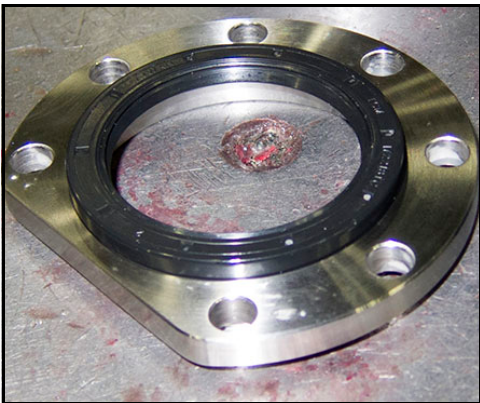
Abbildung 193 - Zentrierung der Lageraufnahmeichtung
