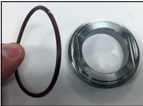
Abbildung 97 - Montage des O-Rings zwischen Kappe und Sitz
