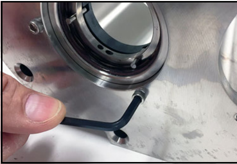
Abbildung 56 - Ausbau der Inbusschrauben
