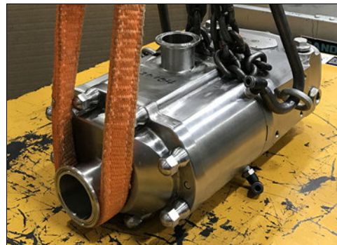
Abbildung 2 - Hebepunkt Detaildarstellung - 015, 030-UTS
