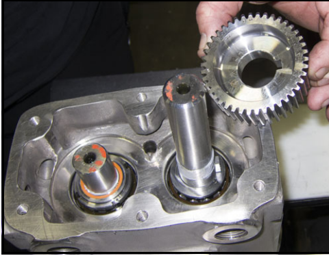
Abbildung 202 - Montage des Antriebszahnrad
