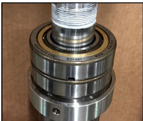
Abbildung 173 - Zweites Lager montiert
