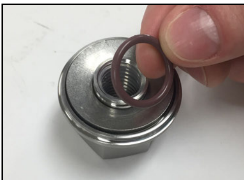
Abbildung 114 - Montage des O-Rings, der die Unterlegscheibe hält
