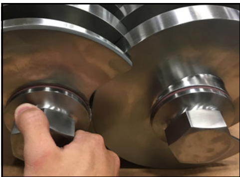
Abbildung 124 - Montage der Rotormuttern
