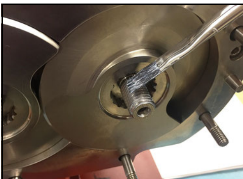
Abbildung 118 - Auftragen von Gleitmittel
