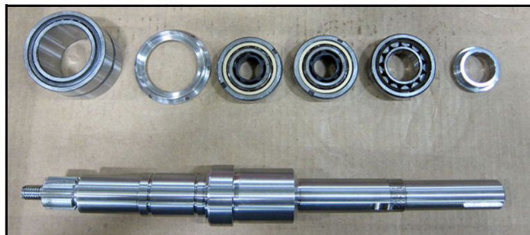
Abbildung 150 - Antriebswelle: Benötigte Elemente der Baugruppe
