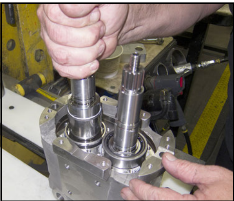
Abbildung 189 - Einsetzen der Antriebswelle in die Bohrung
