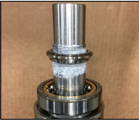
Abbildung 166 - Aufsetzen des Laufrings auf die Welle
