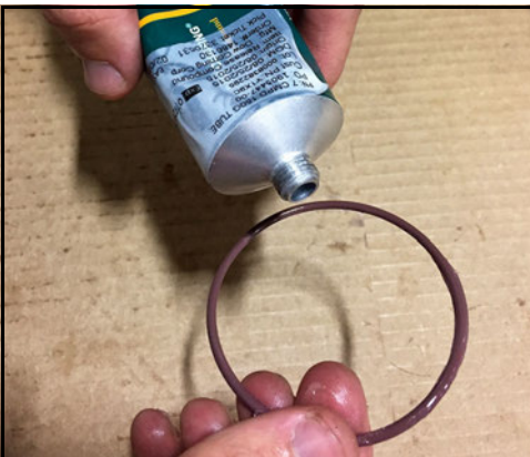
Abbildung 83 - Schmieren der O-Ringe
