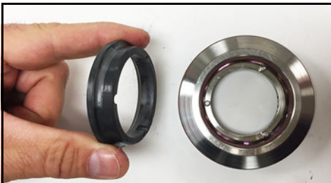
Abbildung 58 - Abnehmen der Dichtung
