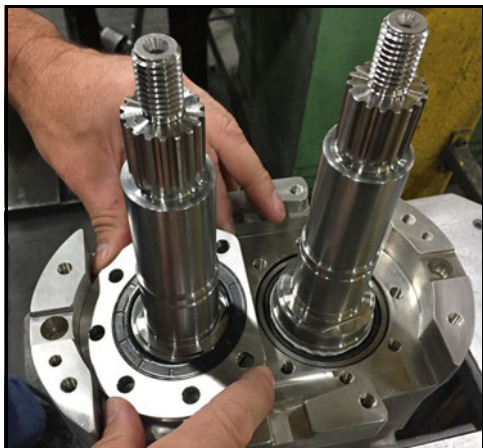
Abbildung 144 - Ausbau der Lageraufnahme
