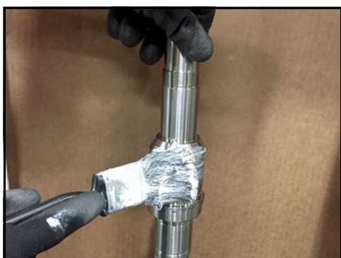
Abbildung 152 - Auftragen von Gleitmittel
