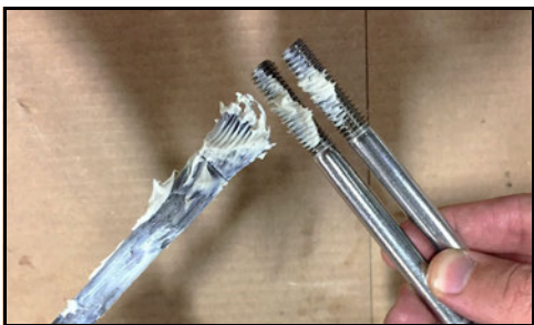
Abbildung 89 - Gleitmittel auf die Gewinde auftragen
