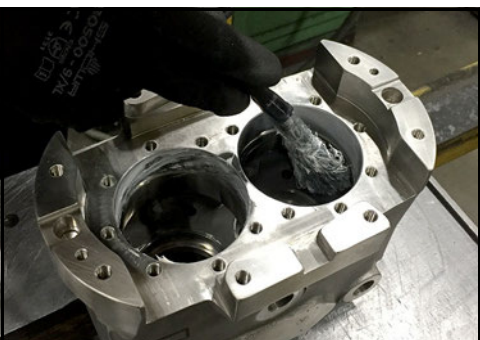
Abbildung 184 - Auftragen von Gleitmittel
