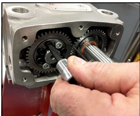
Abbildung 226 - Handfestes Anziehen der Schrauben der Sicherungsbaugruppe
