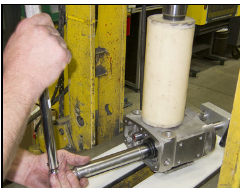
Abbildung 207 - Anziehen der Sicherungsmutter auf Drehmoment
