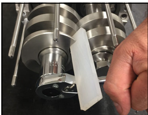
Abbildung 219 - Montage der Rotormuttern
