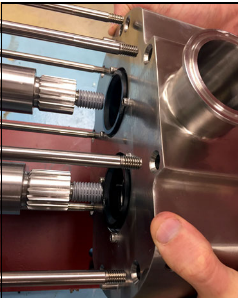
Abbildung 87 - Montage des Pumpengehäuses auf den Wellen
