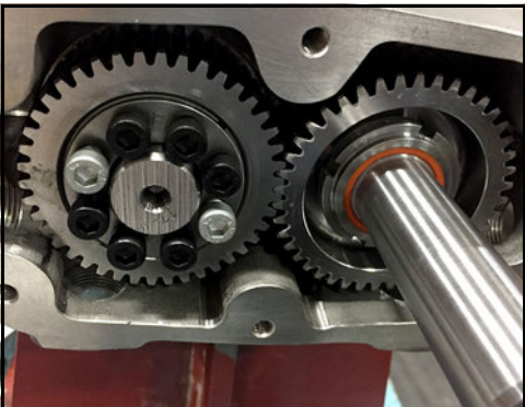
Abbildung 214 - Fluchten des losen Zahn-rads mit dem Antriebszahnrad
