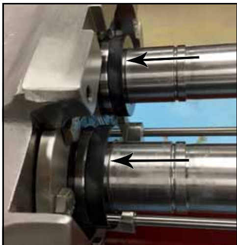
Kuva 86 - Tiivisteiden istukat asennettuina
