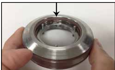
Kuva 59 - Kannattimen ja tiivisteeseen välinen O-rengas asennettuna
