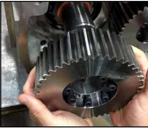
Kuva 213 - Asenna rattaat pumpun akselleille
