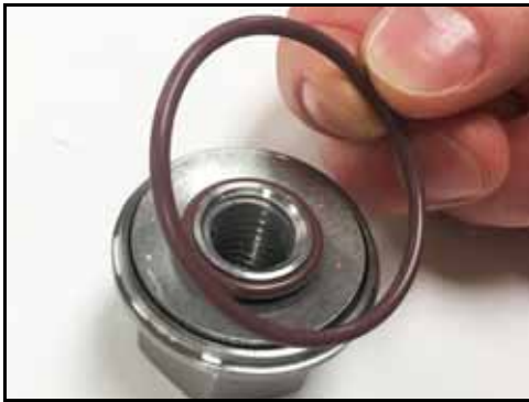
Kuva 38 - Irrota ruuvimutterin O-rengas
