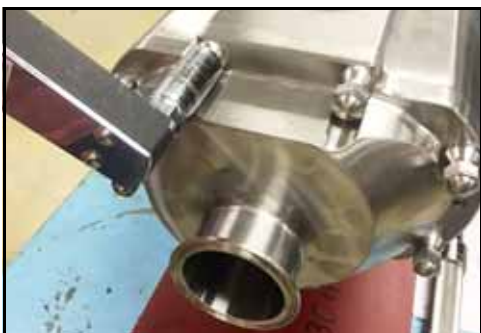
Kuva 27 - Irrota kannen mutterit
