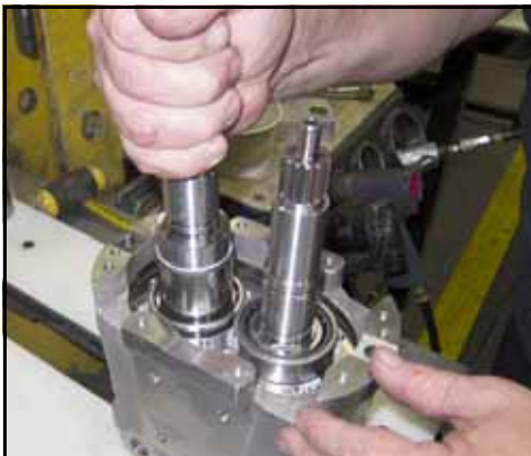
Kuva 189 - Aseta käyttöakseli reikään
