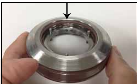
Kuva 70 - Kannattimen ja tiivisteiden välinen O-rengas asennettuna
