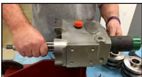
Kuva 147 - Napauta lyhyt akseli rataskotelosta
