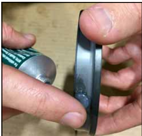
Kuva 81 - Voitele tiivisteen ulkopinta
