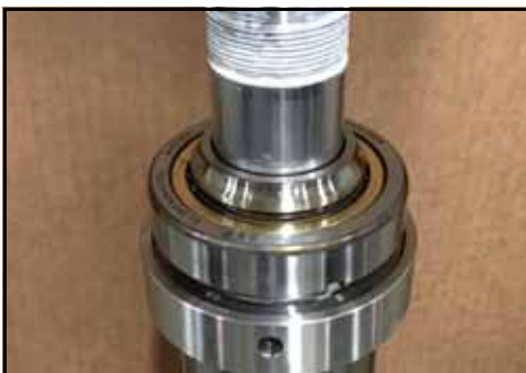
Kuva 169 - Paina kehä laakeriin
