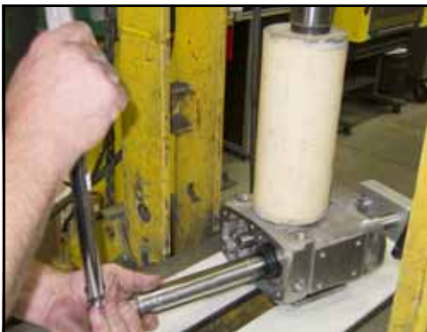
Kuva 207 - Kiristä lukkomutteri momenttiin
