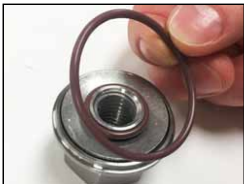
Kuva 116 - Asenna ruuvimutterin O-rengas
