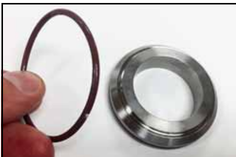
Kuva 99 - Asenna kannen ja ruuvien välinen O-rengas
