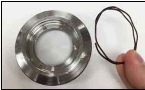
Kuva 60 - Tiiviste en aaltojousi
