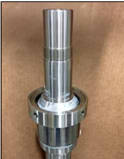
Kuva 158 - Laakerin välilevy asennettuna
