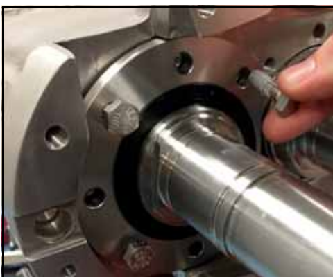
Kuva 143 - Löysää ja irrota laakerin kiinnitysruuvit
