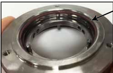
Kuva 72 - Kannattimen ja tiivisteiden välinen O-rengas asennettuna
