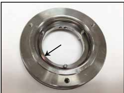
Kuva 71 - Tiivisteiden aaltojousi asennettuna
