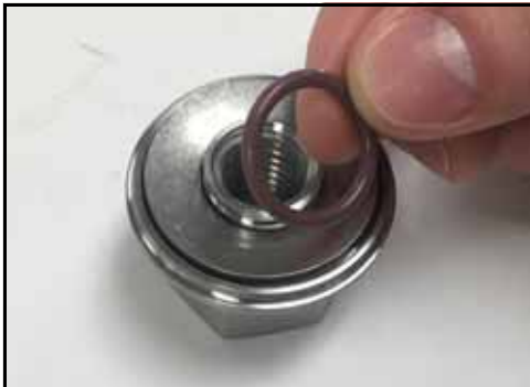
Kuva 39 - Irrota aluslevynpidikkeen O-rengas
