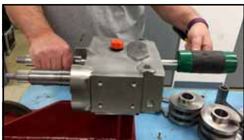
Kuva 145 - Napauta käyttöakseli ulos rataskotelosta
