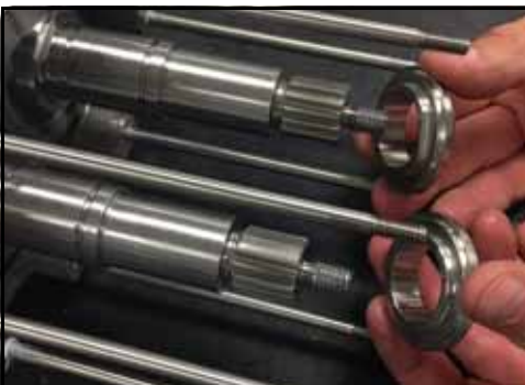
Kuva 215 - Asenna tiivisteiden tulpat
