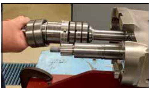
Kuva 146 - Vedä käyttöakseli rataskotelosta
