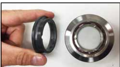
Kuva 73 - Voitele ja asenna tiiviste
