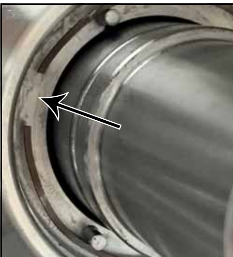
Kuva 68 - Tiivisteiden aaltojousen paikka
