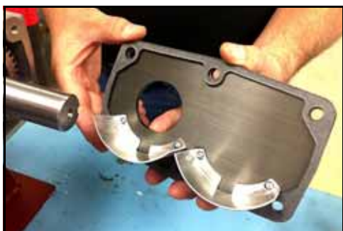
Kuva 234 - Aseta tiiviste kanteen
