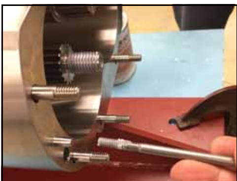
Kuva 51 - Irrota rungon kiinnitysruuvit
