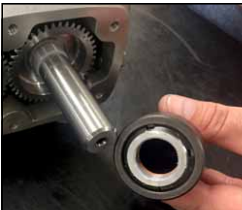
Kuva 142 - Irrota lukkomutteri ja ratas
