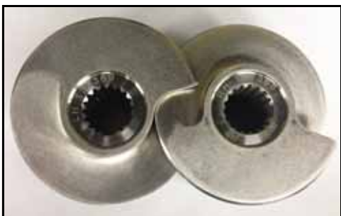
Kuva 42 - Vasen (LH) ja oikea (RH) ruuvi
