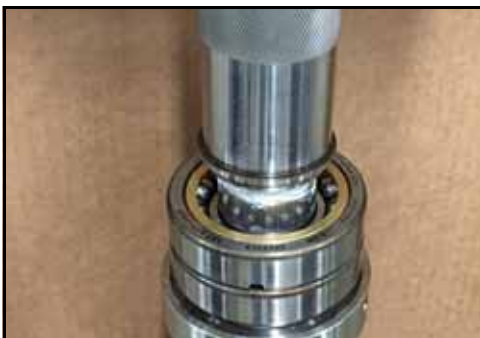
Kuva 172 - Paina kehä laakeriin
