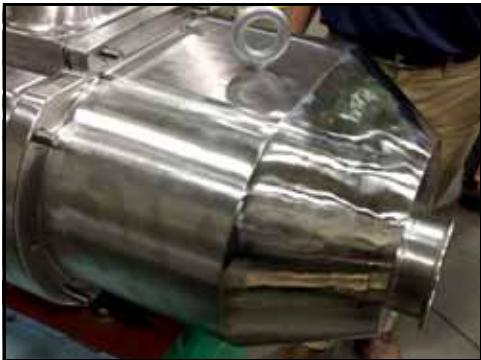
Kuva 130 - Aseta pumpun kansi tiukasti pumpun runkoa vasten
