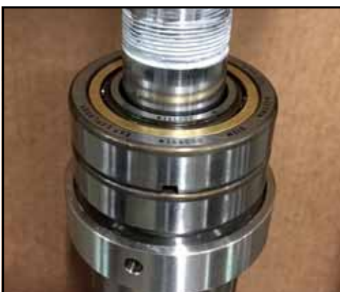
Kuva 173 - Toinen laakeri asennettuna
