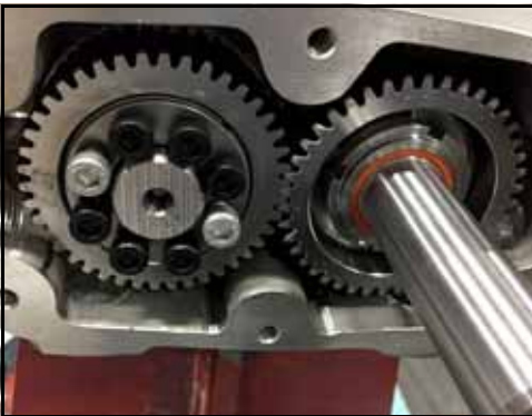
Kuva 214 - Kohdista irtoratas käyttörattaaseen
