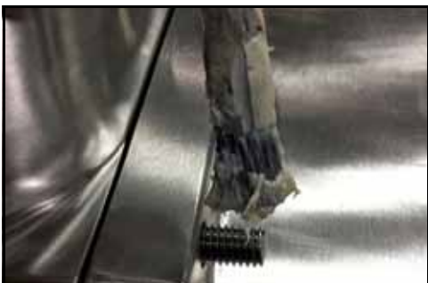
Kuva 131 - Levitä voiteluainetta kierteisiin.
