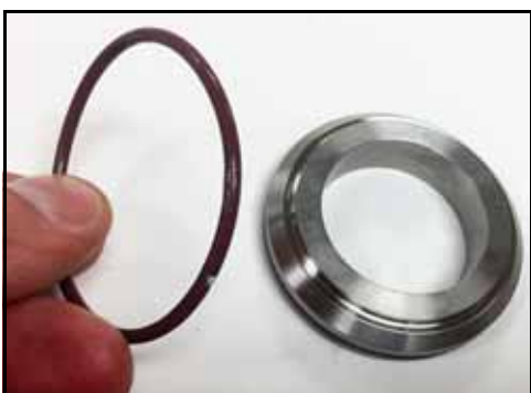
Kuva 45 - Irrota kannen ja ruuvien välinen O-rengas
