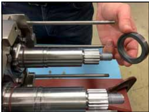
Kuva 85 - Asenna tiivisteiden istukat
