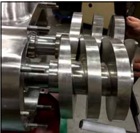
Kuva 110 - Liu'uta ruuvit akseleille
