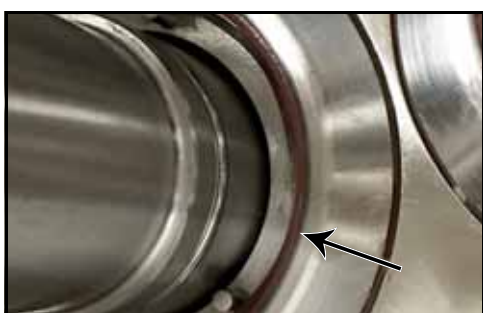
Kuva 93 - Asenna kannattimen ja tiivisteeseen välinen O-rengas
