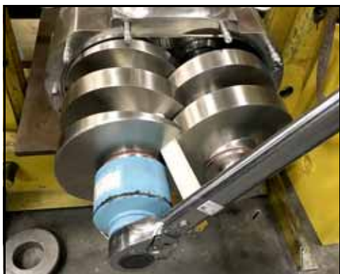
Kuva 125 - Kiristä vasen ruuvimutteri
