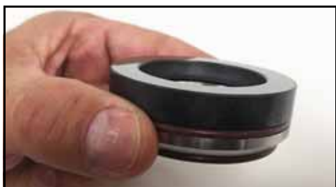
Kuva 102 - Tiivisteeseen istukka asennettuna tiivisteeseen kanteen
