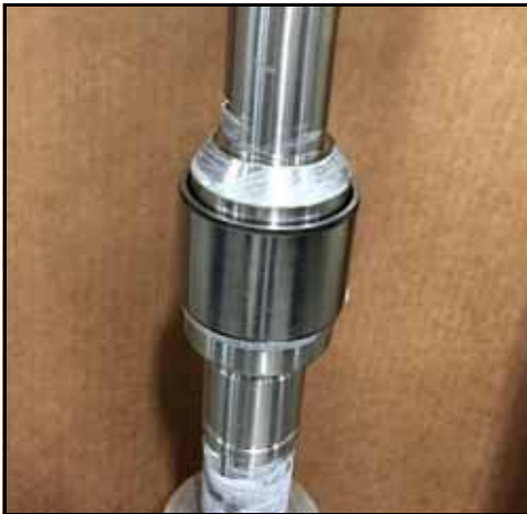
Kuva 156 - Sisäkehä asennettuna akselille
