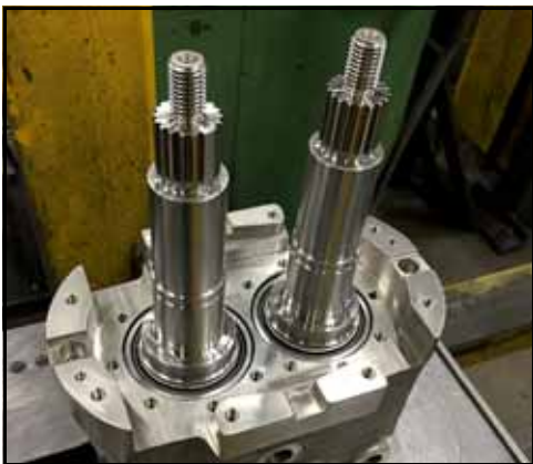
Kuva 192 - Akselit asennettuna rataskoteloon
