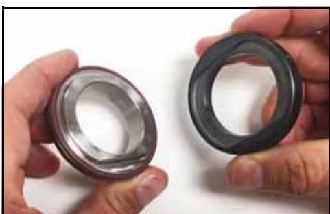
Kuva 44 - Irrota tiivisteen istukka tiivisteen kannesta
