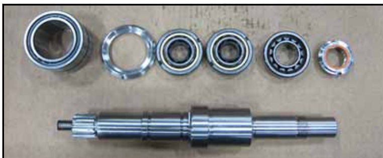
Kuva 151 - Lyhyt akseli: Tarvittavat kokoonpano-osat
