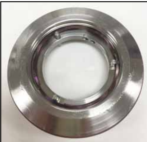
Kuva 67 - Tiivisteiden aaltojousi asennettuna
