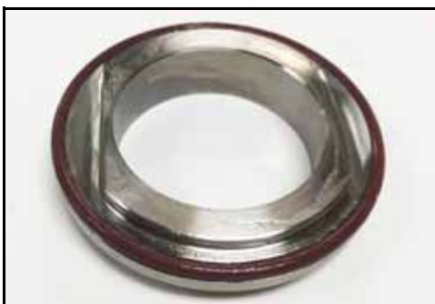
Kuva 98 - Kannen ja istukan välinen O-rengas asennettuna
