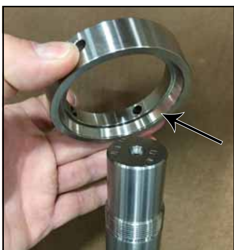
Bild 157 – Placera lagrets mellanlägg på axeln
