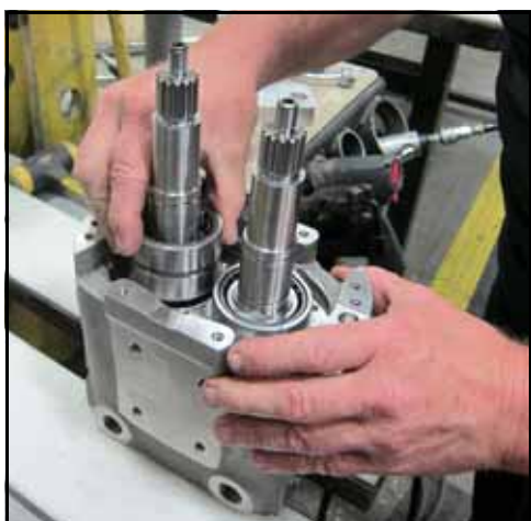
Bild 190 – Placera den yttre ringen på axeln
