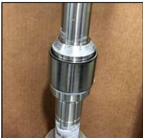
Bild 156 – Den inre ringen är installerad på axeln
