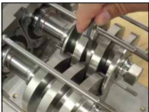
Bild 222 – Mätning av spel
