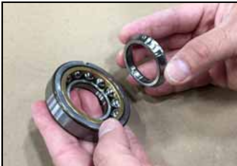
Bild 160 – Ta bort den nedersta ringen
