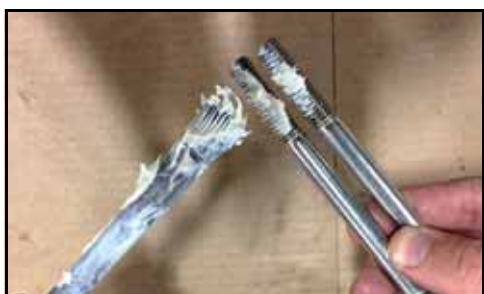
Bild 89 – Applicering av antikärvmiddel på gängorna
