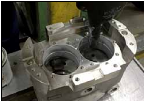
Bild 185 – Sprid ut ett jämnt lager
