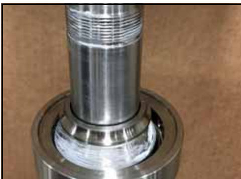
Bild 164 – Ringen fasttryckt på axeln
