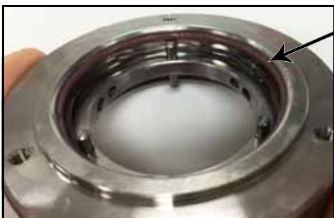
Bild 72 – Monterad O-ring mellan tätningshållare och tätning
