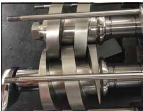
Bild 220 – Montering av fästmuttrar
