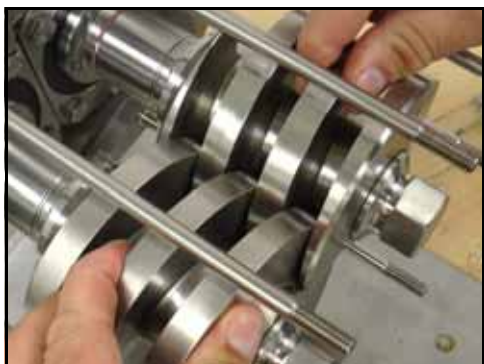
Bild 221 – Mätning av spel
