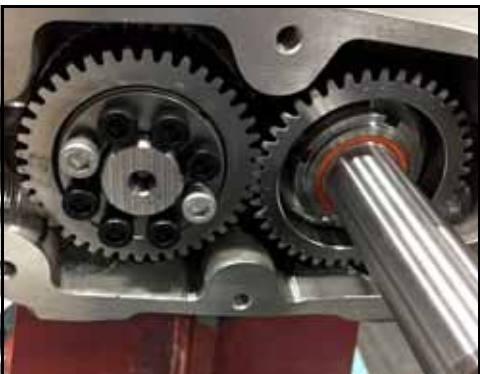
Bild 214 – Rikta in det fria kugghjulet med drivkugghjulet
