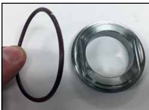
Bild 97 – Montera O-ring som sitter mellan packboxen och sätet
