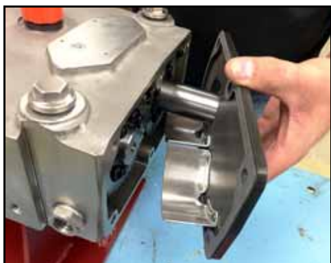
Bild 235 – Montera växellådans hölje
