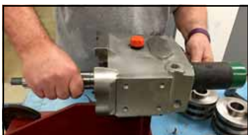
Bild 147 – Knacka loss den korta axeln ur växellådan
