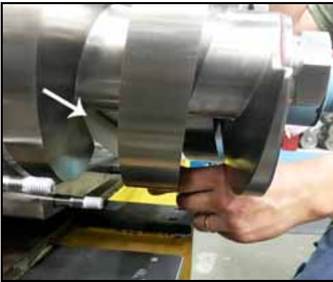
Bild 126 – Blockerad skruv (höger)
