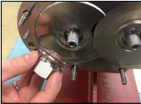
Bild 119 – Montering av fästmuttrar
