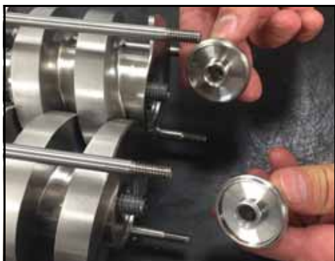
Bild 217 – Montering av fästmuttrar
