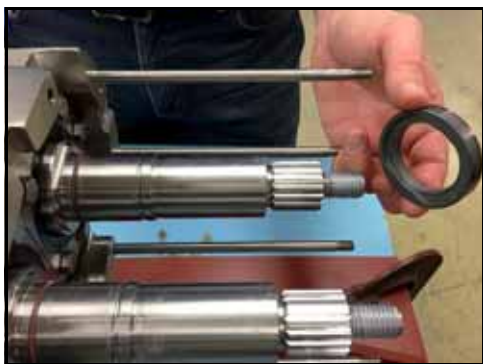
Bild 85 – Montering av tätningarnas säten
