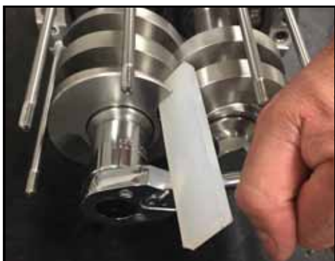
Bild 219 – Montering av fästmuttrar
