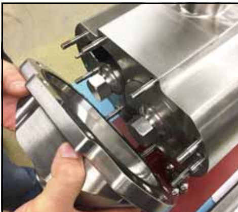
Bild 128 – Montering av pumphölje
