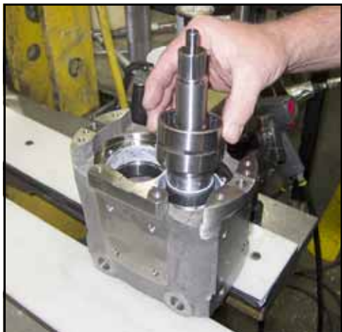
Bild 188 – Placera den yttre ringen på axeln
