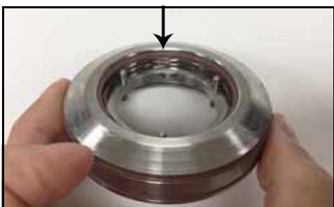
Bild 70 – Monterad O-ring mellan tätningshållare och tätning
