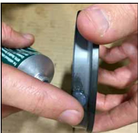
Bild 81 – Smörj tätningens utsida
