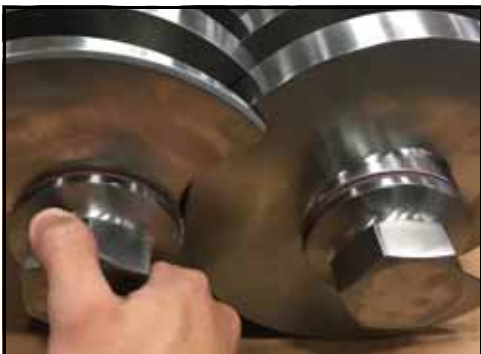
Bild 124 – Montering av fästmuttrar
