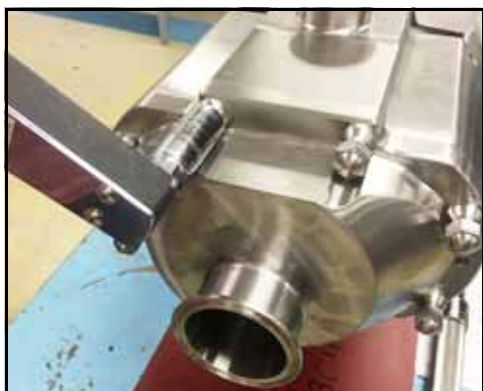
Bild 132 – Åtdragning av lockmuttrar
