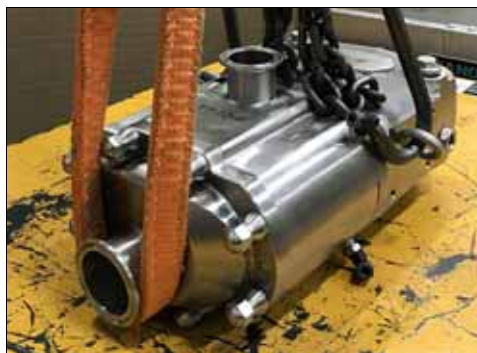
Bild 2 – Detalj från placering av lyftanordningar – 015, 030-UTS
