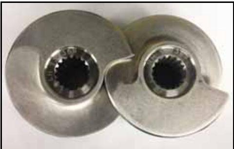
Bild 107 – Placera skruvarna på detta sätt: LH-RH
