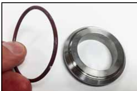
Bild 99 – Montera O-ring mellan packbox och skruv
