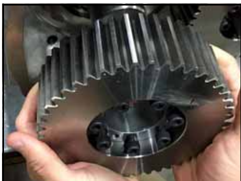
Bild 139 – Ta av kugghjul
