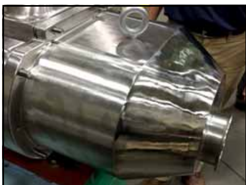
Bild 130 – Pumphöljet monterat på pumphuset
