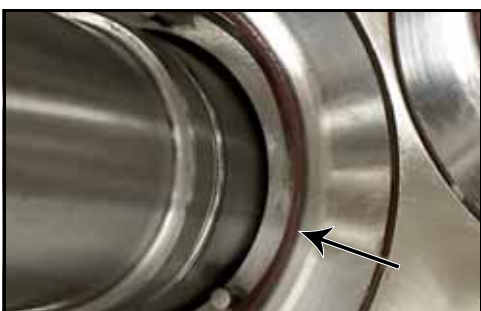
Bild 93 – Montera O-ring mellan tätningsinsats och tätning
