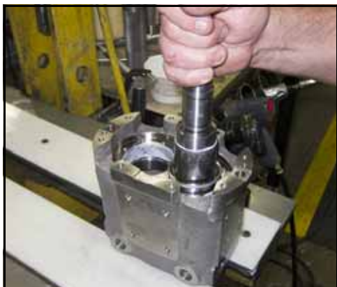
Bild 186 – Placera den korta axeln i hålet
