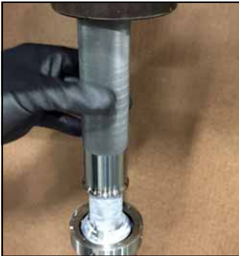
Bild 163 – Tryck fast ringen på axeln
