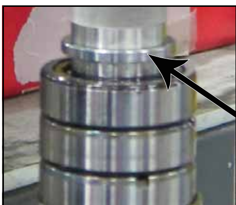
Bild 180 – Tryck fast lagrets mellanlägg på drivaxeln
