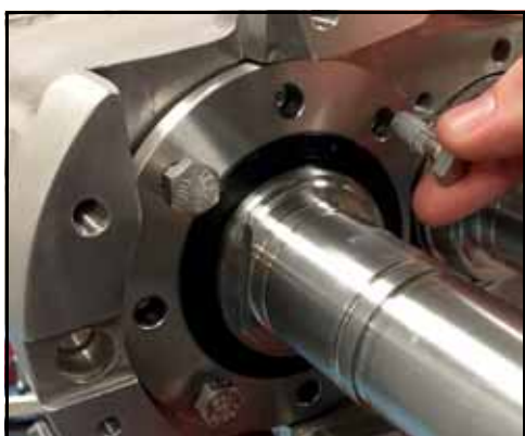
Bild 143 – Lossa och ta bort lagerhållarens fästsruvar
