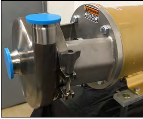
Figura 116 - Apriete a mano la abrazadera de la carcasa
