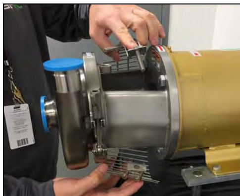
Figura 11 - Conjunto de protección
