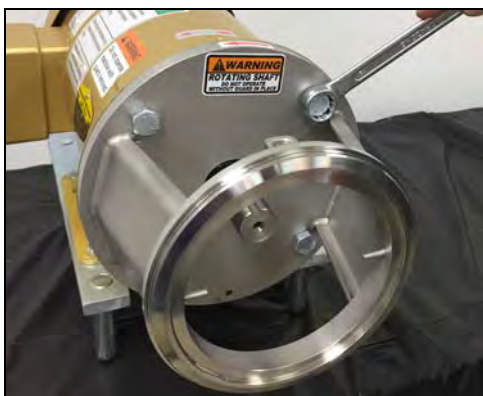
Figura 74 - Retire los pernos de retención del adaptador del motor
