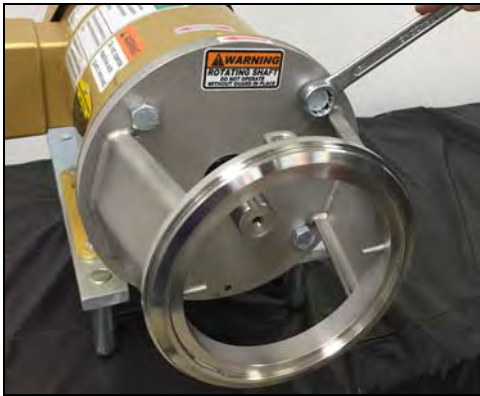
Figura 25 - Retire los pernos del adaptador del motor
