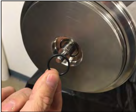
Figura 105 - Instale la junta tórica del eje de acople
