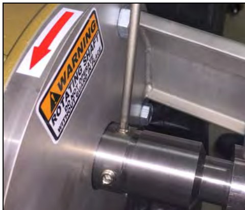
Figura 23 - Impulsor del pasador: Afloje los tornillos de fijación
