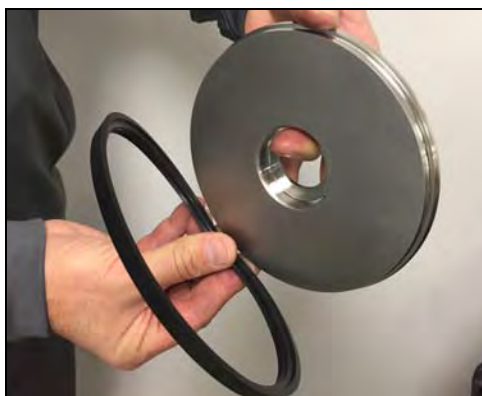
Figura 46 - Instale la cubierta
