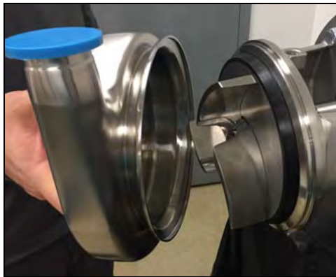
Figura 52 - Instale la cubierta
