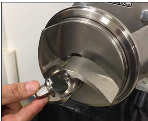
Figura 89 - Instale la tuerca del impulsor
