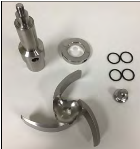
Figura 76 - Componentes del impulsor sellado
