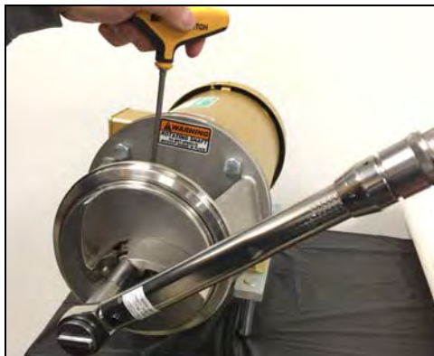
Figura 60 - Afloje la tuerca del impulsor
