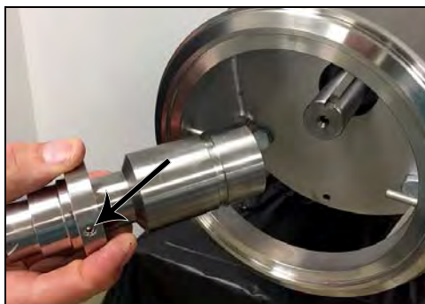
Figura 24 - Impulsor del pasador: Tire del eje de acople del eje del motor
