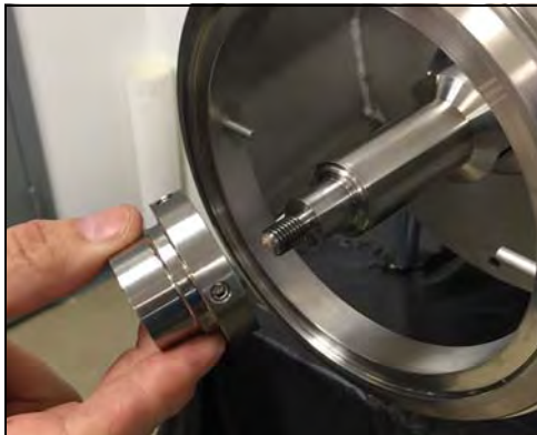
Figura 93 - Coloque el collar de accionamiento en el eje de acople
