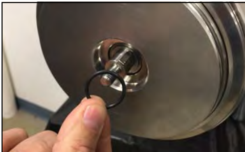
Figura 64 - Retire la junta tórica del eje de acople
