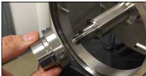
Figura 71 - Retire el collar de accionamiento
