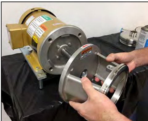
Figura 26 - Retire el adaptador del motor
