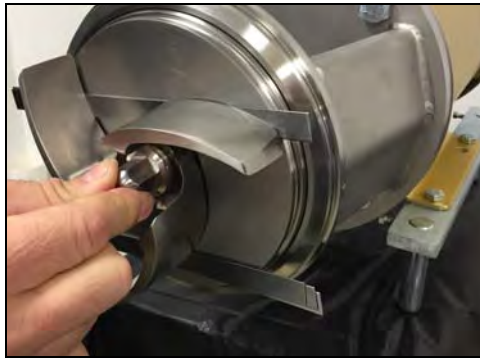
Figura 90 - Coloque las cuñas
