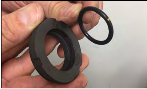
Figura 96 - Instalar la junta tórica
