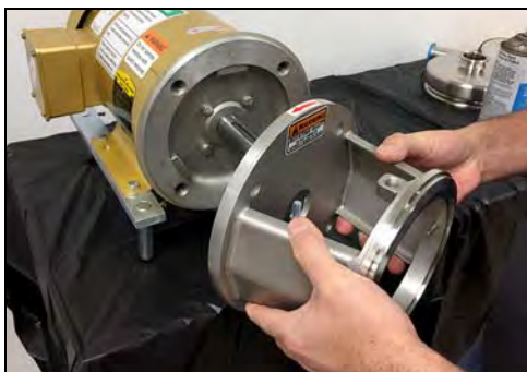
Figura 75 - Retire el adaptador del motor
