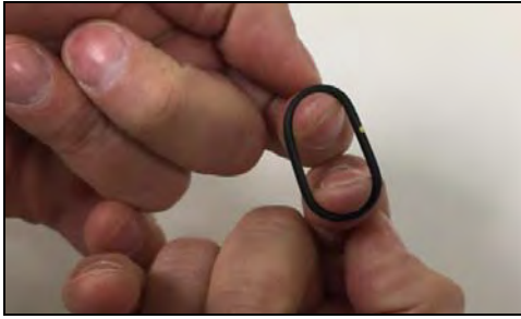
Figura 104 - Estire un poco la junta tórica
