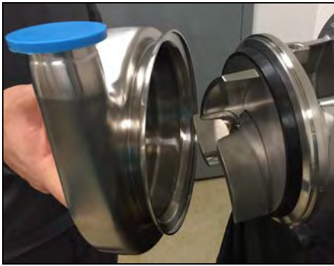
Figura 13 - Retire la carcasa
