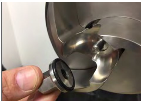
Figura 61 - Retire la tuerca del impulsor
