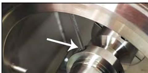
Figura 70 - Afloje los tornillos de fijación
