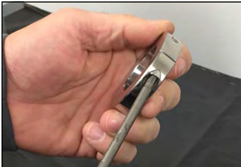
Figura 79 - Retire los tornillos del collar del eje
