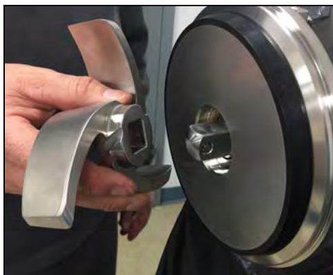
Figura 35 - Deslice el impulsor en el eje
