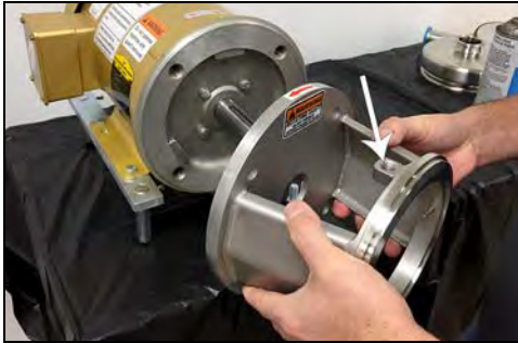
Figura 27 - Instale el adaptador del motor
