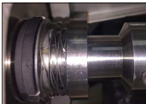
Figura 102 - Sello con placa trasera instalada
