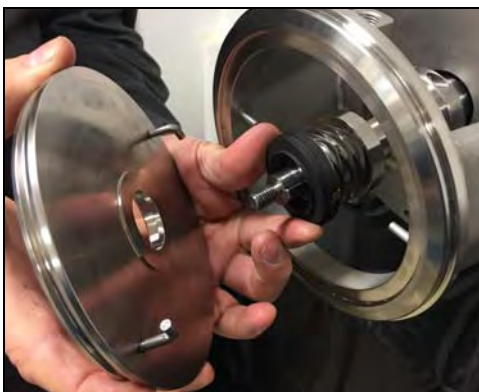
Figura 65 - Instale la placa trasera
