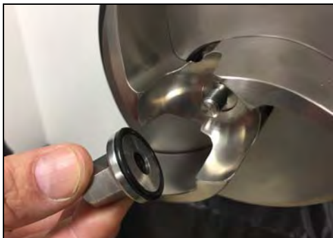
Figura 109 - Instale la tuerca del impulsor
