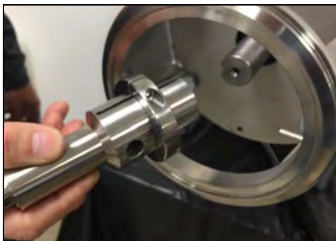
Figura 73 - Deslice el eje de acople del eje del motor
