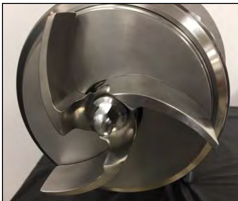
Figura 110 - Apriete a mano la tuerca del impulsor
