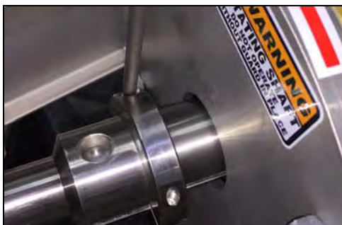
Figura 72 - Afloje los tornillos del collar del eje
