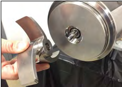
Figura 63 - Retire el impulsor
