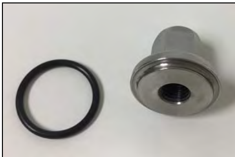
Figura 108 - Instale la junta tórica en la tuerca del impulsor
