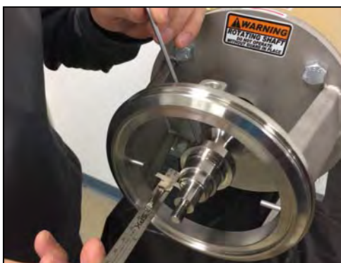
Figura 95 - Apriete los tornillos de fijación
