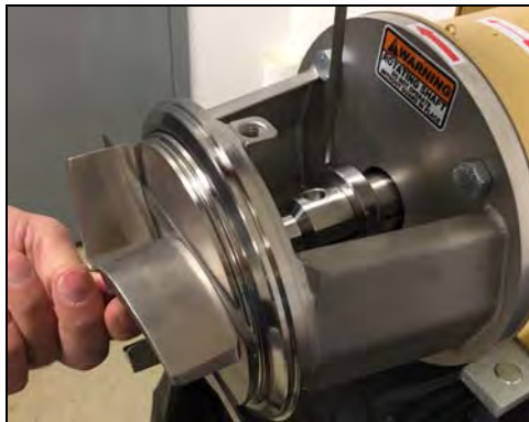
Figura 91 - Apriete los tornillos
