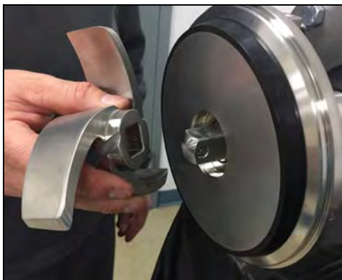
Figura 50 - Instale el impulsor
