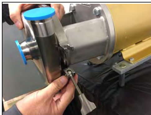
Figura 12 - Retire la abrazadera de la carcasa
