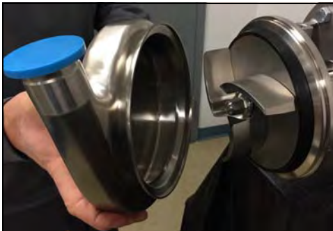
Figura 114 - Instale la cubierta
