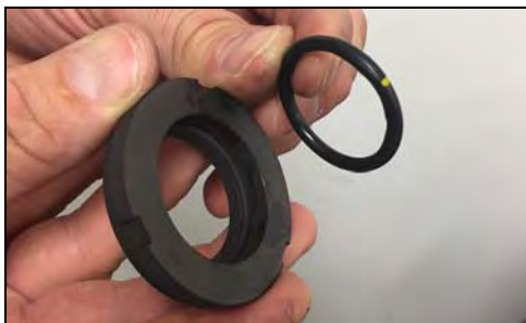
Figura 20 - Retire la junta tórica
