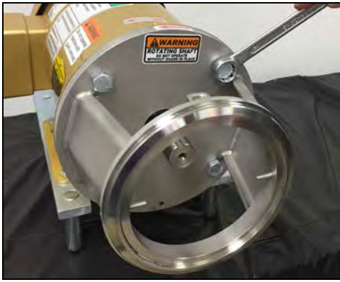
Figura 78 - Instale los pernos del adaptador del motor
