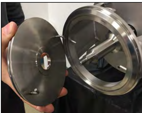
Figura 84 - Instale la placa trasera
