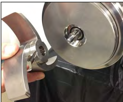
Figura 107 - Instale el impulsor en el eje de acople
