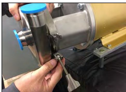
Figura 56 - Retire la abrazadera de la carcasa
