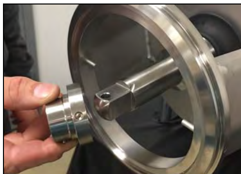
Figura 39 - Deslice el collar de impulsión en el eje
