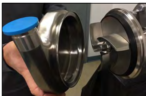
Figura 57 - Retire la carcasa
