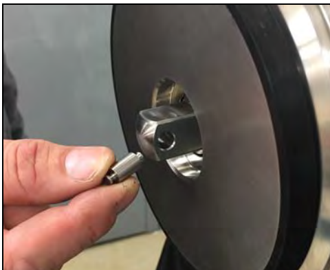
Figura 33 - Inserte el pasador de retención del impulsor
