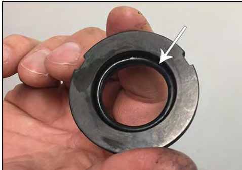
Figura 97 - Junta tórica de sello instalada
