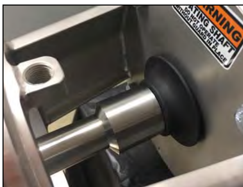
Figura 38 - Deslice el deflector en el eje
