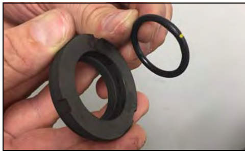
Figura 68 - Retire la junta tórica
