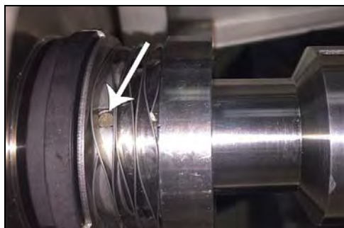
Figura 100 - Pasador del eje de acople en la ranura
