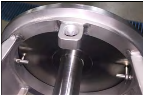
Figura 32 - Pasadores de la placa trasera enganchados con los pasadores del adaptador
