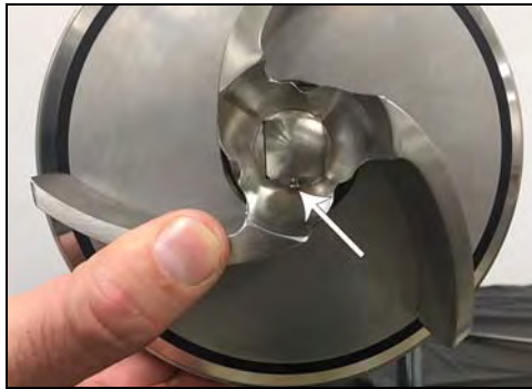
Figura 51 - Pasador del impulsor asegurado
