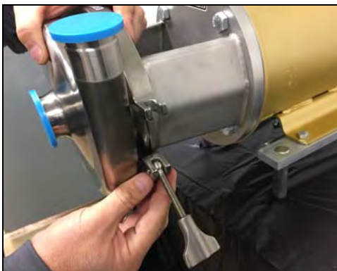
Figura 115 - Instale la abrazadera de la carcasa
