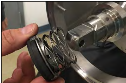
Figura 19 - Retire el sello, la junta tórica, la junta hermética y el resorte
