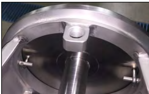
Figura 48 - Pasadores de la placa trasera enganchados
