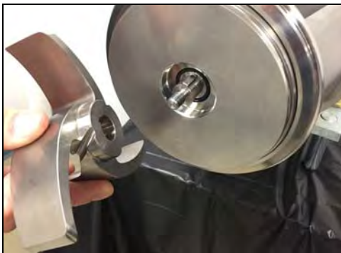
Figura 88 - Instale el impulsor
