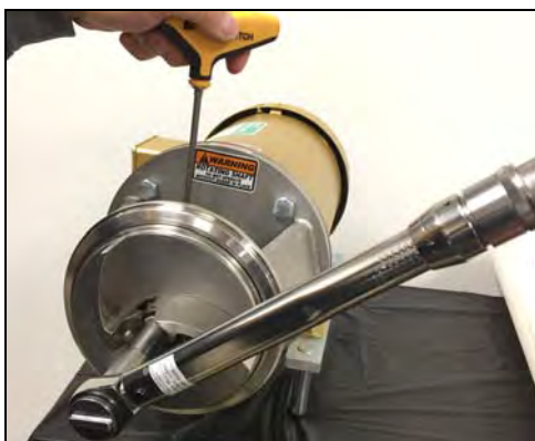
Figura 111 - Apriete la tuerca del impulsor
