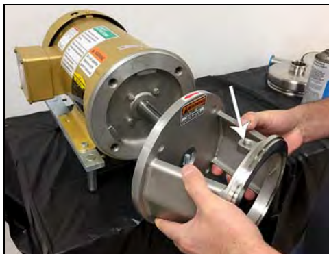
Figura 77 - Instale el adaptador del motor
