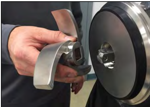
Figura 15 - Retire el impulsor
