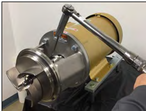
Figura 92 - Apriete los tornillos del collar del eje
