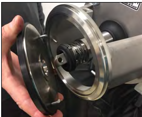
Figura 47 - Instale la placa trasera
