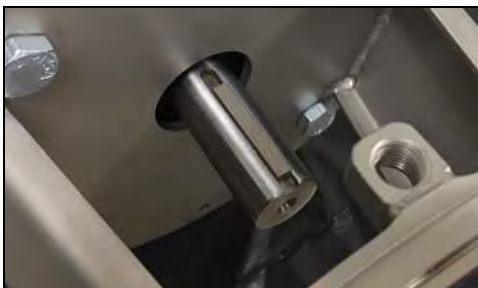
Figura 29 - Instale la llave en el eje del motor
