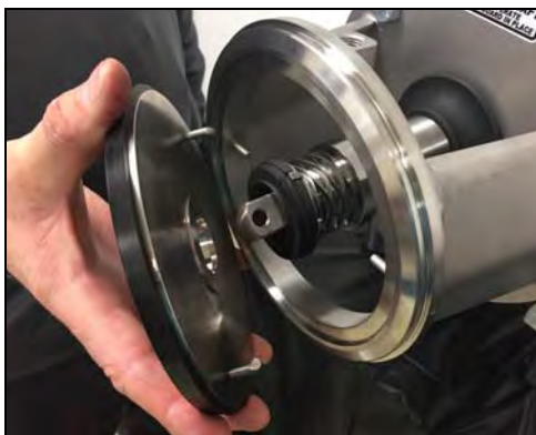
Figura 17 - Retire la placa trasera
