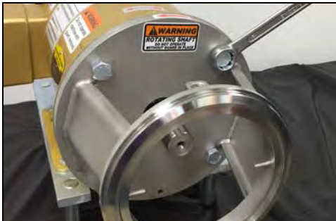
Figura 28 - Instale los pernos del adaptador del motor
