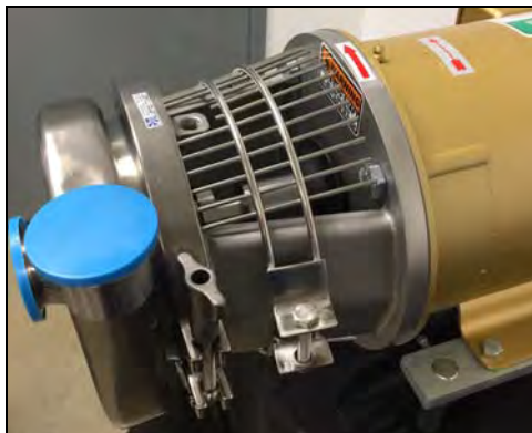
Figura 54 - Instale el conjunto de protección
