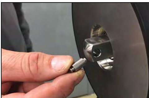
Figura 16 - Retire el pasador del impulsor
