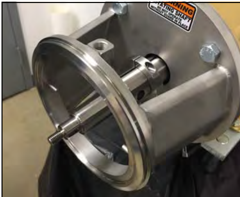
Figura 83 - Eje de acople en el eje del motor
