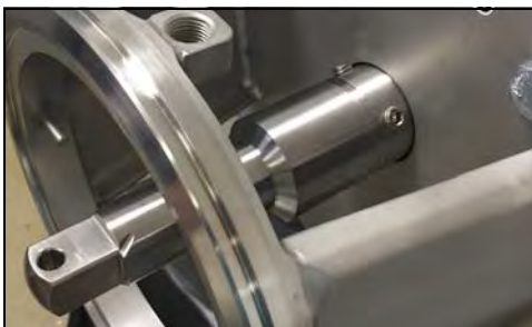
Figura 30 - Eje de acople en el eje del motor
