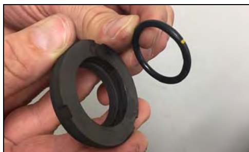
Figura 42 - Lubricar e instalar la junta tórica
