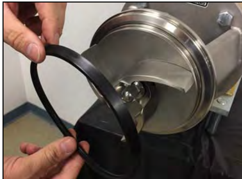
Figura 59 - Retire la junta de la carcasa
