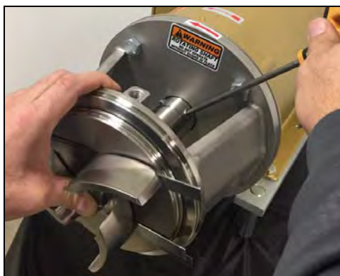
Figura 37 - Coloque el calibrador de espesores, apriete los tornillos de fijación
