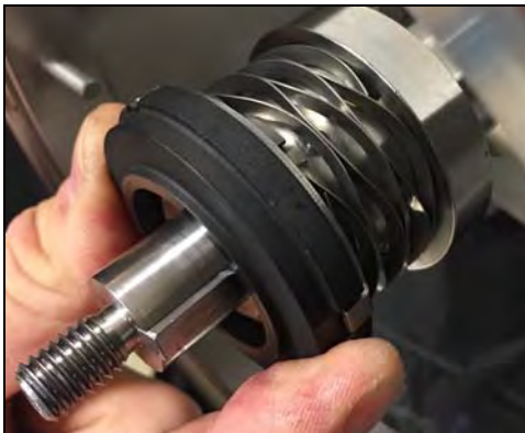
Figura 99 - Empuje el sello en el eje de acople
