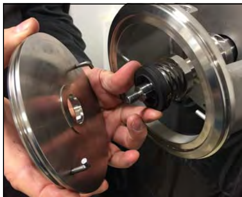
Figura 101 - Instale la placa trasera
