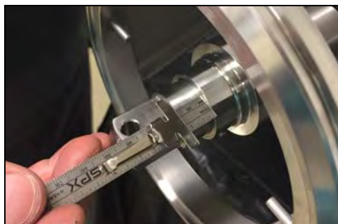
Figura 40 - Ubique el collar de accionamiento
