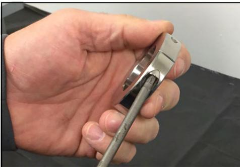
**Figura 79 - Retire los tornillos del collar del eje**
