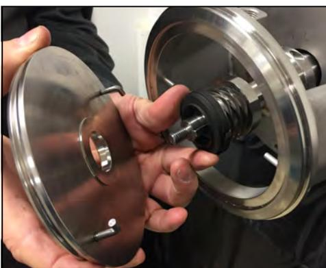
**Figura 65 - Instale la placa trasera**
