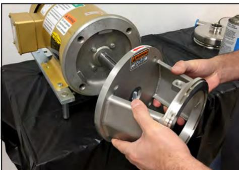
**Figura 75 - Retire el adaptador del motor**
