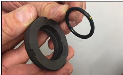
**Figura 68 - Retire la junta tórica**
