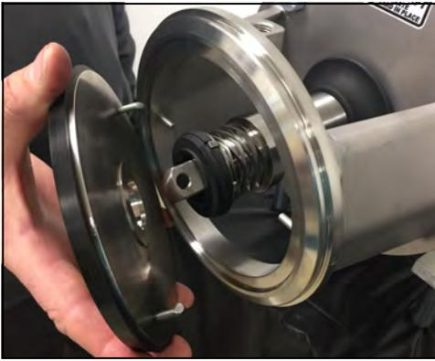
Figura 47 - Instale la placa trasera
