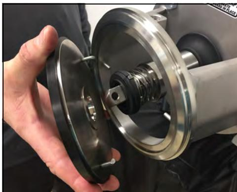
**Figura 17 - Retire la placa trasera**
