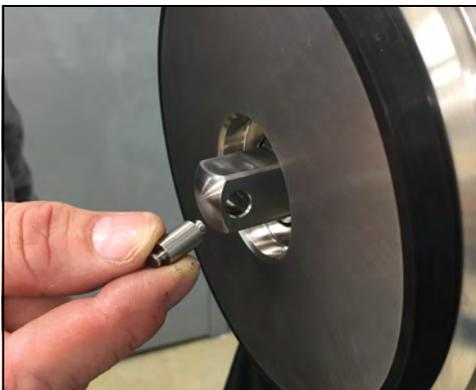
**Figura 33 - Inserte el pasador de retención del impulsor**
