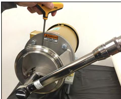
**Figura 60 - Afloje la tuerca del impulsor**
