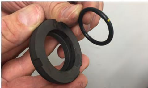
**Figura 96 - Instalar la junta tórica**
