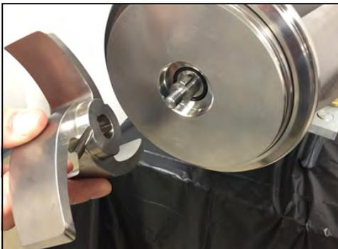
**Figura 88 - Instale el impulsor**
