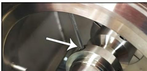
**Figura 70 - Afloje los tornillos de fijación**
