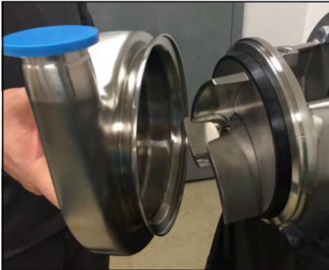
**Figura 52 - Instale la cubierta**
