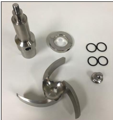
**Figura 76 - Componentes del impulsor sellado**
