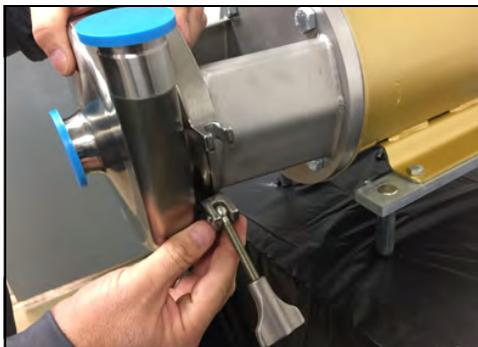
**Figura 56 - Retire la abrazadera de la carcasa**
