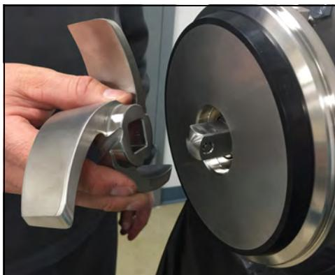
**Figura 35 - Deslice el impulsor en el eje**
