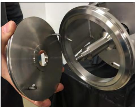
**Figura 84 - Instale la placa trasera**
