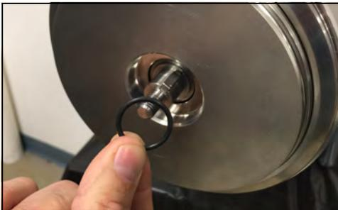
**Figura 64 - Retire la junta tórica del eje de acople**
