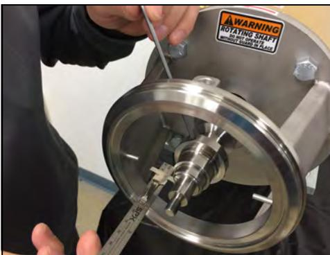
**Figura 95 - Apriete los tornillos de fijación**
