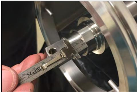
**Figura 40 - Ubique el collar de accionamiento**
