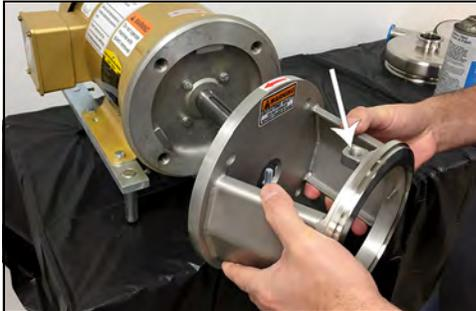
**Figura 27 - Instale el adaptador del motor**
