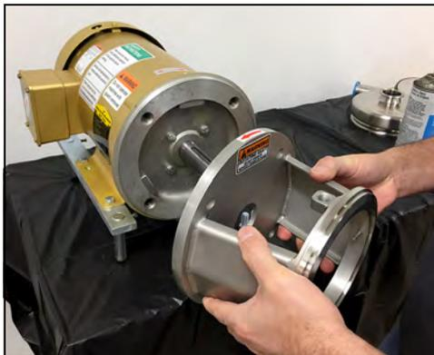
**Figura 26 - Retire el adaptador del motor**
