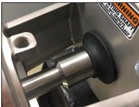
**Figura 38 - Deslice el deflector en el eje**
