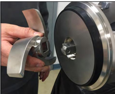
Figura 50 - Instale el impulsor
