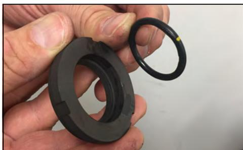
**Figura 20 - Retire la junta tórica**
