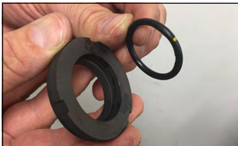
**Figura 42 - Lubricar e instalar la junta tórica**
