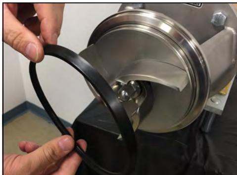
**Figura 59 - Retire la junta de la carcasa**
