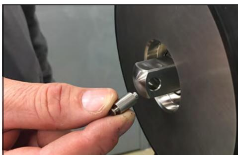
**Figura 16 - Retire el pasador del impulsor**
