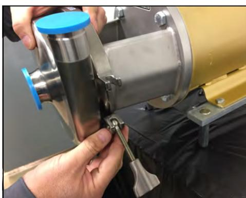
**Figura 115 - Instale la abrazadera de la carcasa**
