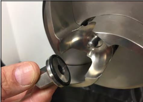
**Figura 109 - Instale la tuerca del impulsor**
