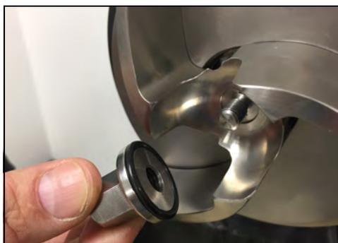
**Figura 61 - Retire la tuerca del impulsor**
