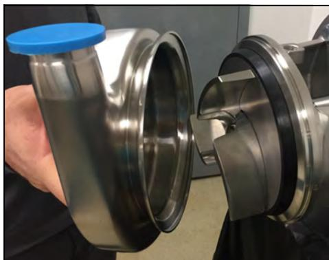
**Figura 13 - Retire la carcasa**
