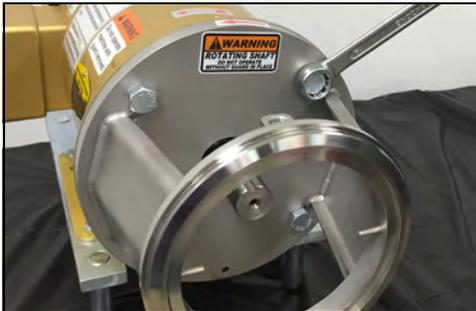
**Figura 28 - Instale los pernos del adaptador del motor**
