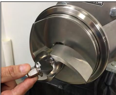
**Figura 89 - Instale la tuerca del impulsor**
