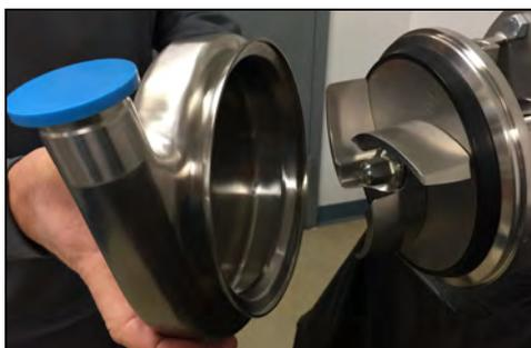
**Figura 57 - Retire la carcasa**
