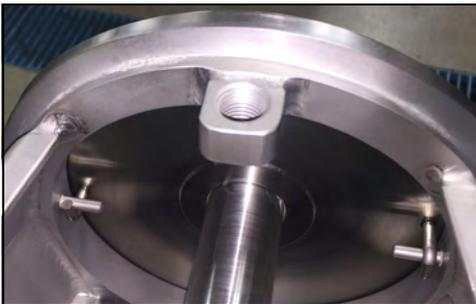
Figura 48 - Pasadores de la placa trasera enganchados
