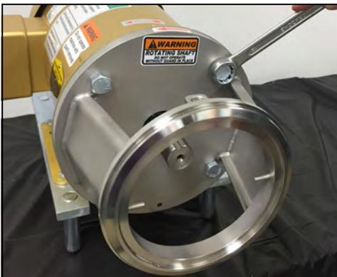
**Figura 74 - Retire los pernos del adaptador del motor**
