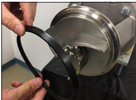
**Figura 112 - Coloque la junta de la carcasa sobre la placa trasera**
