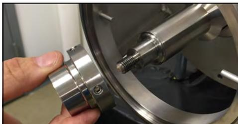
**Figura 71 - Retire el collar de accionamiento**
