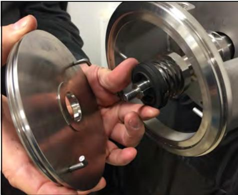
**Figura 101 - Instale la placa trasera**
