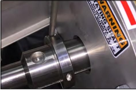
**Figura 72 - Afloje los tornillos del collar del eje**
