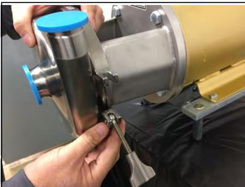
**Figura 12 - Retire la abrazadera de la carcasa**
