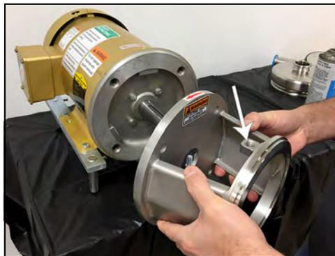
**Figura 77 - Instale el adaptador del motor**
